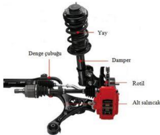
Şekil 3.6. MacPherson süspansiyon
