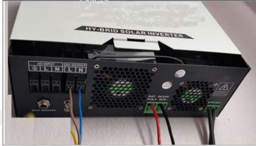
Şekil 4.15. İnverterin enerji giriş çıkışlarının görünümü
