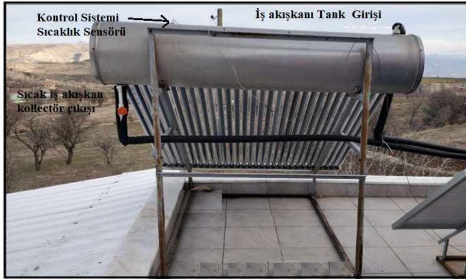
Şekil 4.22. Güneş kollektörü iş akışkanı giriş çıkış noktaları ve sıcaklık ölçüm sensör konumu
