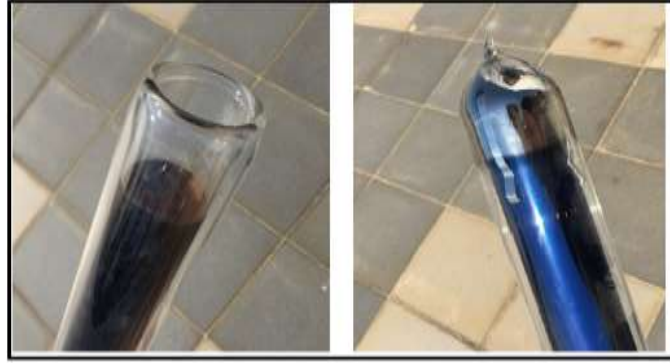
Şekil 4.23. Vakumlu cam tüpün iş akışkanı giriş yeri ve cam tüpün vakumlanarak kapatılmış son kısmı
