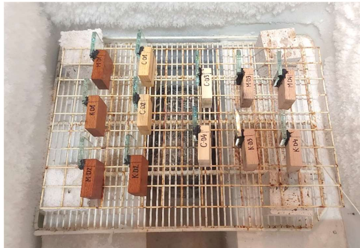
Şekil 3.10 : Donma-çözünme deneyi numuneleri.
