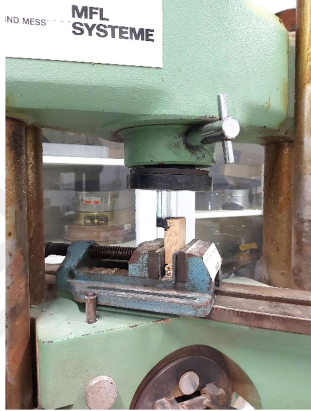
Şekil 3.5 : Kayma deneyinde kullanılan Universal cihazı.
