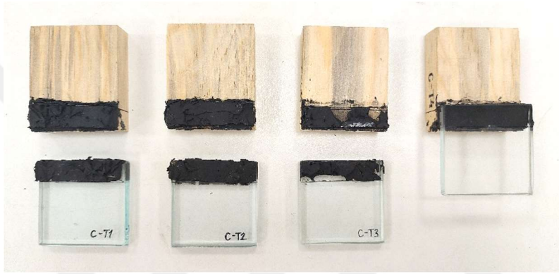
Şekil 4.10 : Masif çam ile oluşturulmuş numunelerin yüksek sıcaklığa maruziyetinin ardından yapılan kayma deneyi sonucu.
