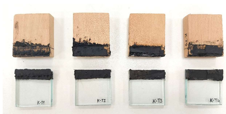
Şekil 4.17 : Masif kayın ile oluşturulmuş numunelerin yüksek sıcaklığa maruziyetinin ardından yapılan kayma deneyi sonucu.
