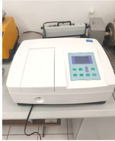
Şekil 3.12 : Renk değişimi tayini için kullanılan spektrofotometre cihazı.
