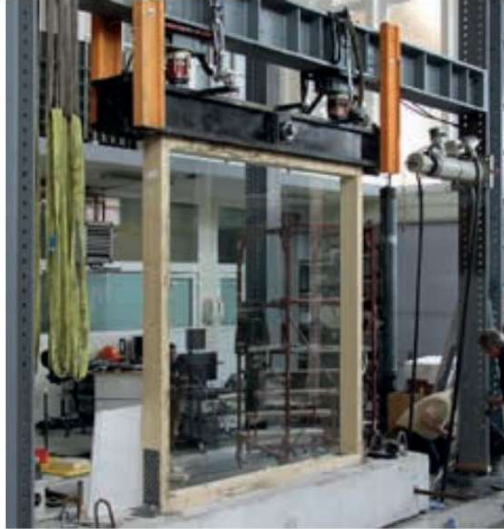
Şekil 2.24 : Ahşap-cam kompozit duvar üzerinde gerçekleştirilen deneysel çalışma (Nicklisch ve diğ, 2015).
