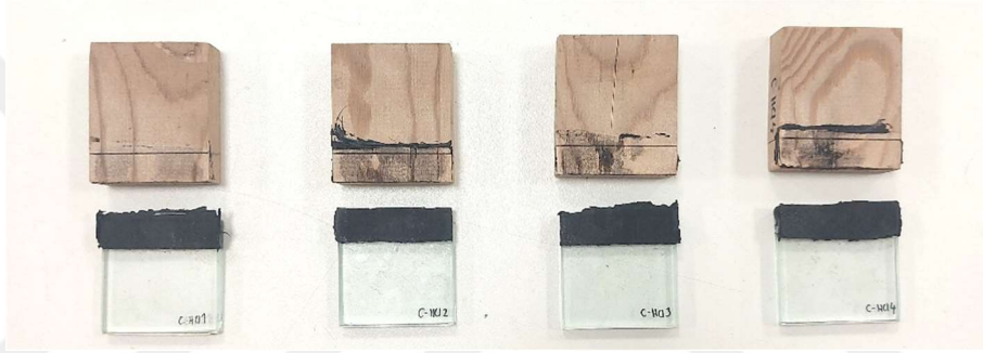
Şekil 4.7 : Masif çam ile oluşturulmuş numunelerin HCl asite maruz bırakılmasının ardından yapılan kayma deneyi sonucu.
