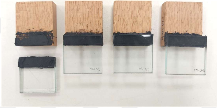
Şekil 4.23 : Masif meşe ile oluşturulmuş numunelerin UV ışığa maruziyetinin ardından yapılan kayma deneyi sonucu.
