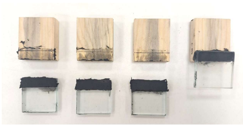
Şekil 4.5 : Masif çam ile oluşturulmuş numunelerin ıslanma-kuruma sonrası kayma deneyi sonucu.
