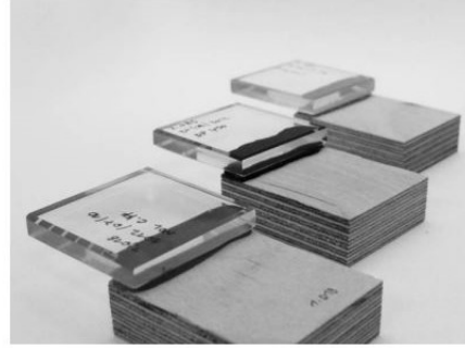
Şekil 2.19 : Ahşap-cam kompozit cephe malzemesi üzerine yapılan deneysel çalışmalardan numuneler (Nicklisch ve diğ, 2014).
