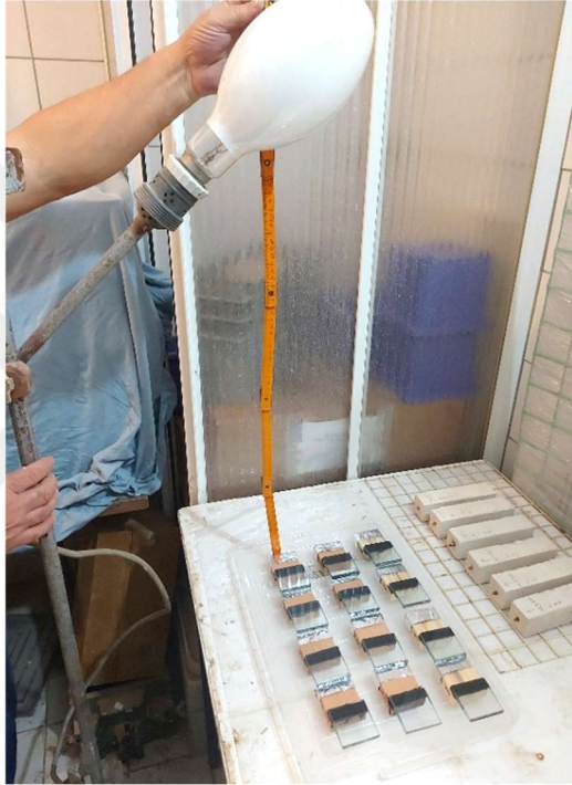
Şekil 3.11 : UV ışığına maruz kalan deney numuneleri.
