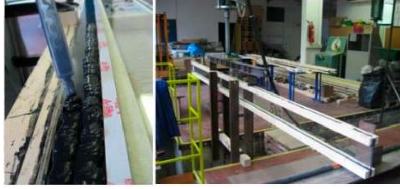
Şekil 2.23: Ahşap-cam kompozit kirişler için gerçekleştirilmiş deneyler (Drzecnik ve diğerleri, 2022).
