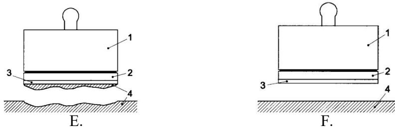
Şekil 4.31 : E.) Cam içerisinde kopma F.) Yapıştırıcı ile cam arasında kopma
