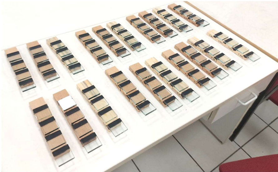
Şekil 3.4 : Kayma deneyi için oluşturulan ahşap-cam kompozit numuneler.
