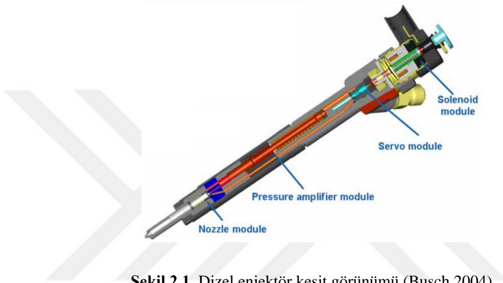
Şekil 2.1. Dizel enjektör kesit görünümü (Busch,2004)
