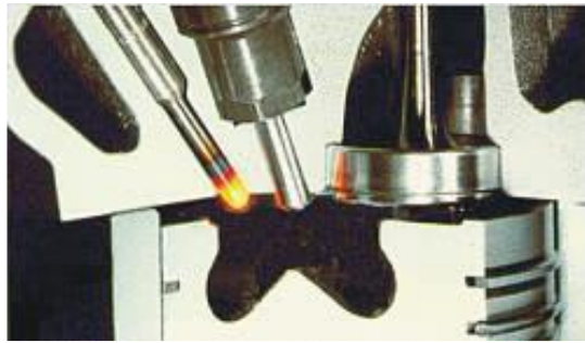
Şekil 2.5. Yanma odası (Bey ve Böge,2007)
