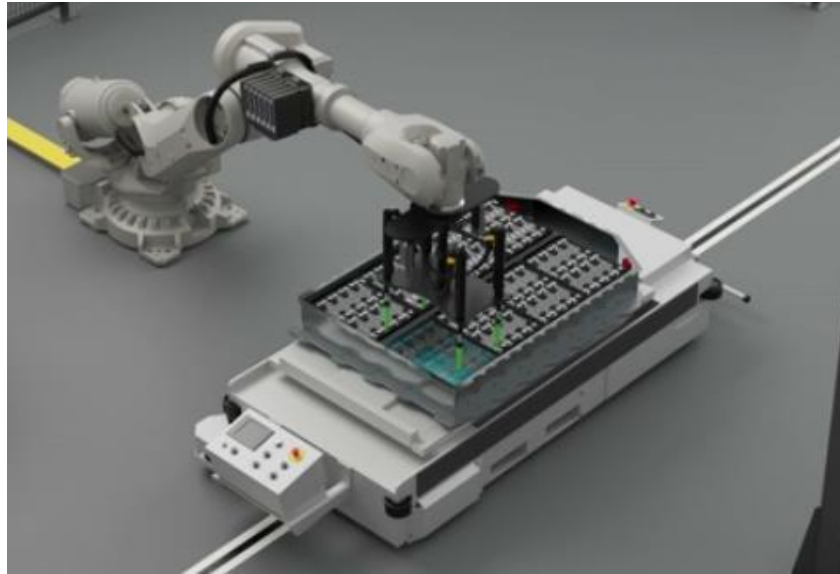
Şekil 2.4. Batarya paketi-modül yerleştirme uygulaması (Atlas C. 2022).
