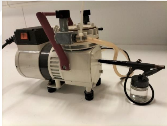
Şekil 3.3: Sprey kaplama yöntemi kullanılan kaplama düzeneği.
