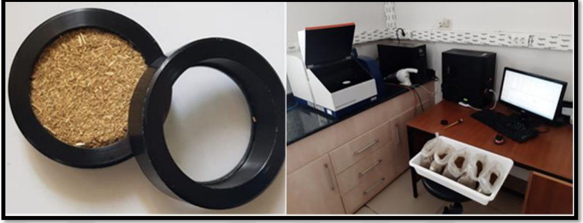
Şekil 3.11. NIR cihazında örneklerin okutulması
