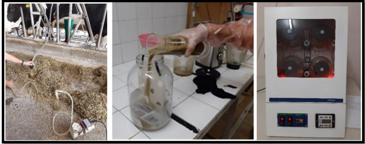
Şekil 3.8. Rumen sıvısının alınması ve Daisy İnkübatöre yerleştirilmesi
