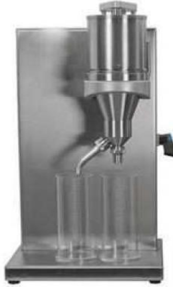
Şekil 4.8. Drenaj ölçümleri için kullanılan Schopper-Reigler (SR°) cihazı
