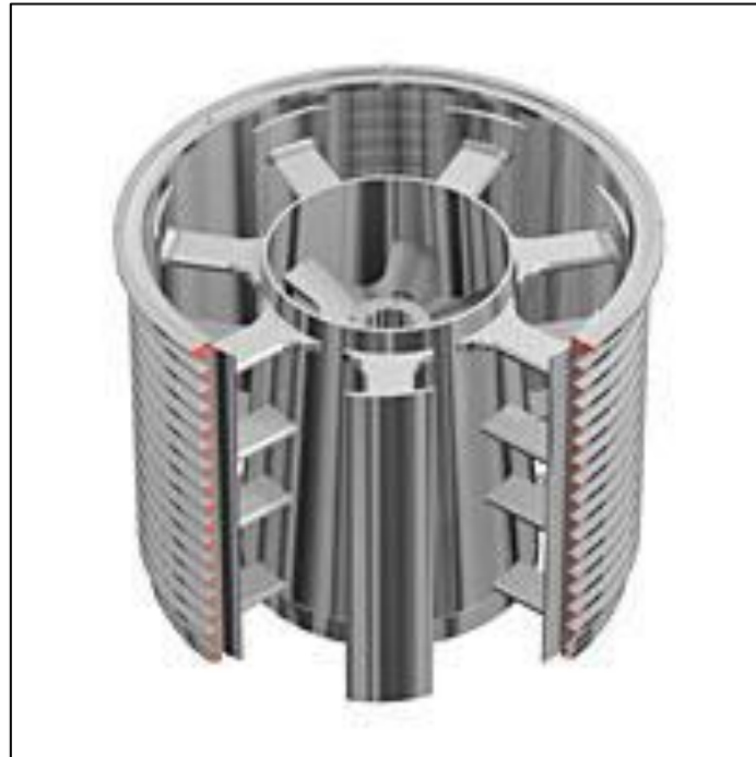
Şekil 2.7. Hamur temizleme eleği iç kısım gösterimi (Keşmer, 2013)
