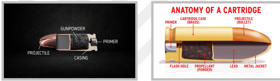
Şekil 2.11: Fişegin bölümleri : Kapsül, Kovan, Barut, Çekirdek.
