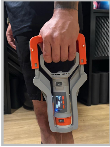
Şekil 3.4: Vald Dinamometre ile El kavrama Kuvvet ölçümü.
