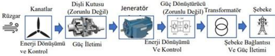
Şekil 2.7. Rüzgâr Türbini Çalışma Prensibi [20]
