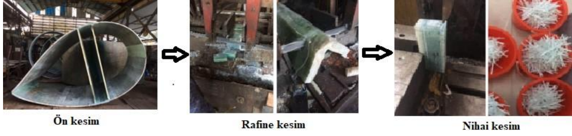
Şekil 4.2. Bir rüzgâr türbini kanadının mekanik dönüşüm aşamaları [58]
