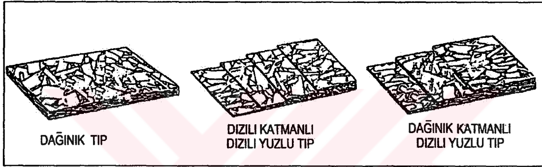
Şekil 3.15. OSB levha katman yapısı (SBA Association, 1998)
