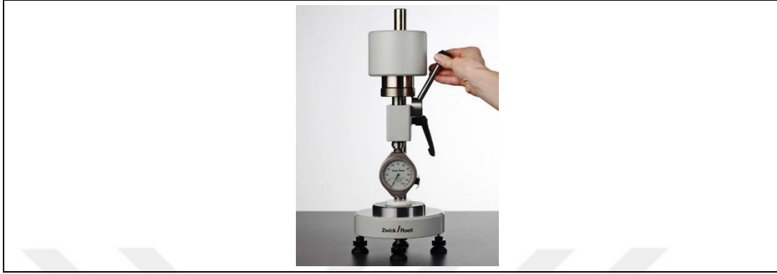
Şekil 5.17. Sertlik ölçüm cihazı Zwick/Roell (Shore A) (URL-50)
