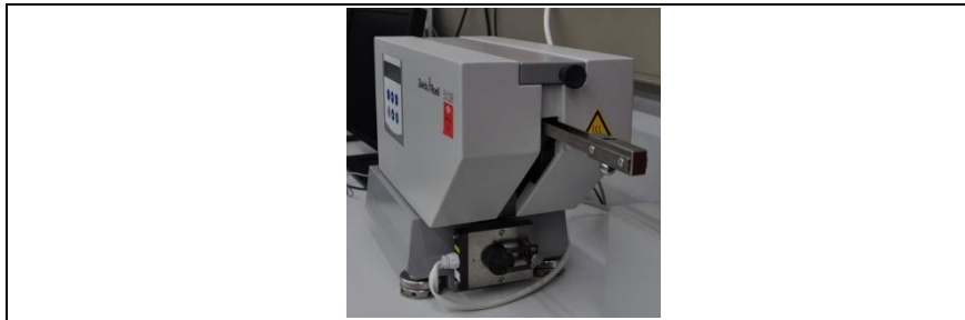
Şekil 5.20. Zwick 5109 Sekme Esnekliği Test Cihazı (URL-52)
