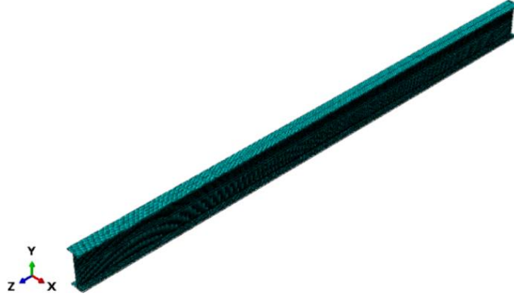
Şekil 3.5. Kabuk eleman ile oluşturulan I kiriş modeli
