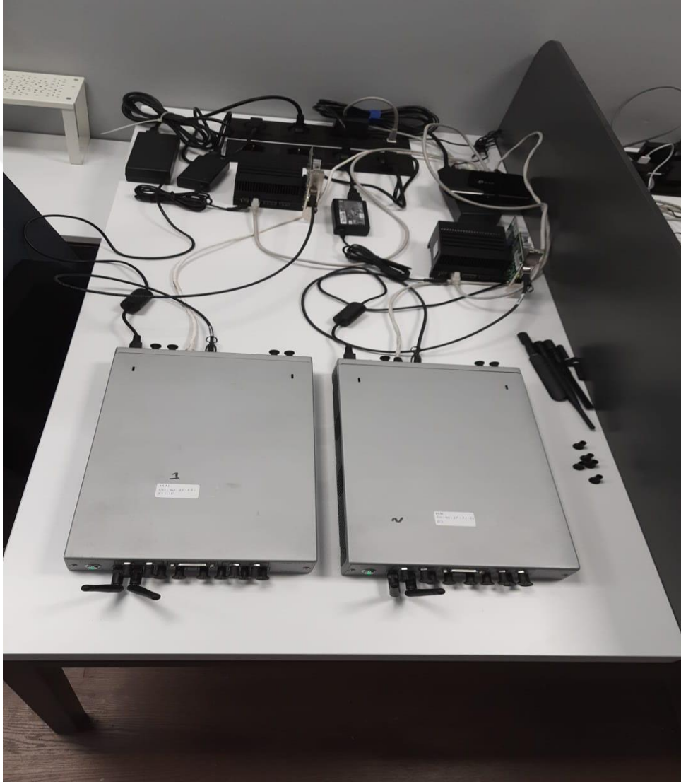
řekil 3.12 SDR ile AGX cihazının aė zerinde baėlantısı
