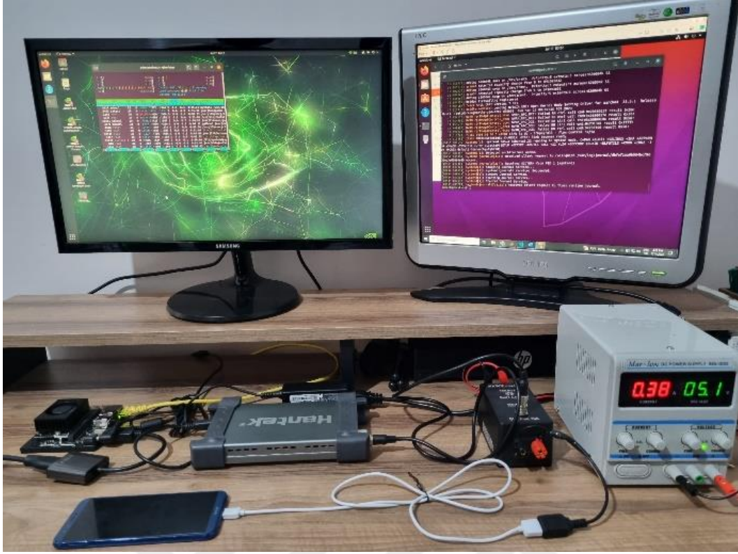
Şekil 5.13 İletilen Emisyon sinyalleri aracılığıyla tanımlama yapmak için oluşturulan kurulum
