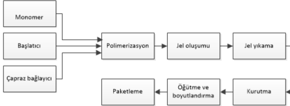
Şekil 2.18. Polimerizasyon yöntemi ile hidrojel sentezinin proses şeması (Sujitha ve ark. 2023)
