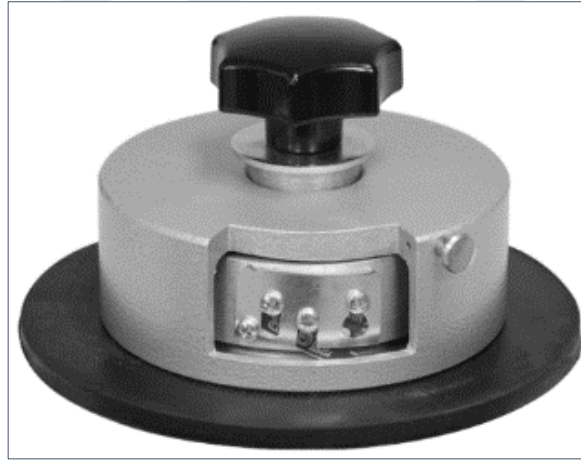
Şekil 3.18. Kumaş gramajı test numunesi kesim aleti
