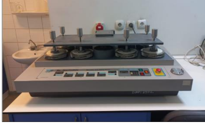
Şekil 3.8. Martindale aşındırma ve boncuklanma test cihazı
