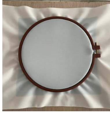
Şekil 3.10. Nakış kasnağına gerilmiş test numunesi
