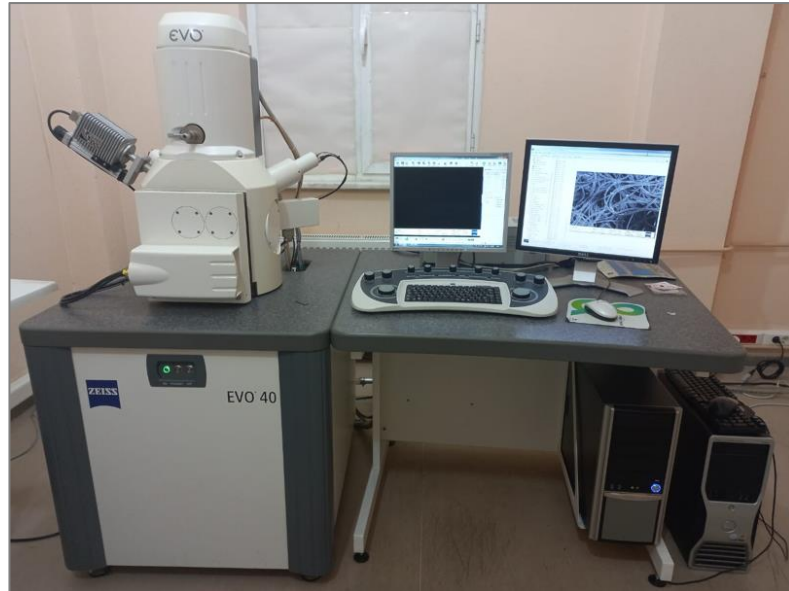
Şekil 3.22. Zeiss EVO 40 taramalı elektron mikroskobu (SEM)
