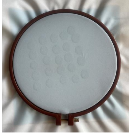
Şekil 3.12. Su emme hızı testi uygulanmış numune örneği
