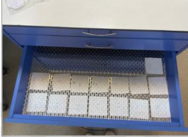
Şekil 3.4. Fizik laboratuvarında kondisyonlamaya bırakılan test numuneleri
