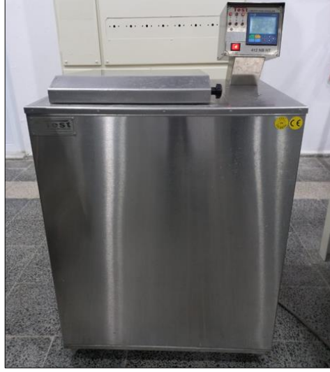
Şekil 3.20. Yıkama dayanımı için Test 412 NB HT yıkama makinesi
