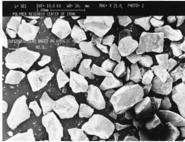
Şekil 2.20. Çözelti polimerizasyonundan elde edilen SEP'in öğütülmüş SEM görüntüsü (Omidian ve ark. 1999)
