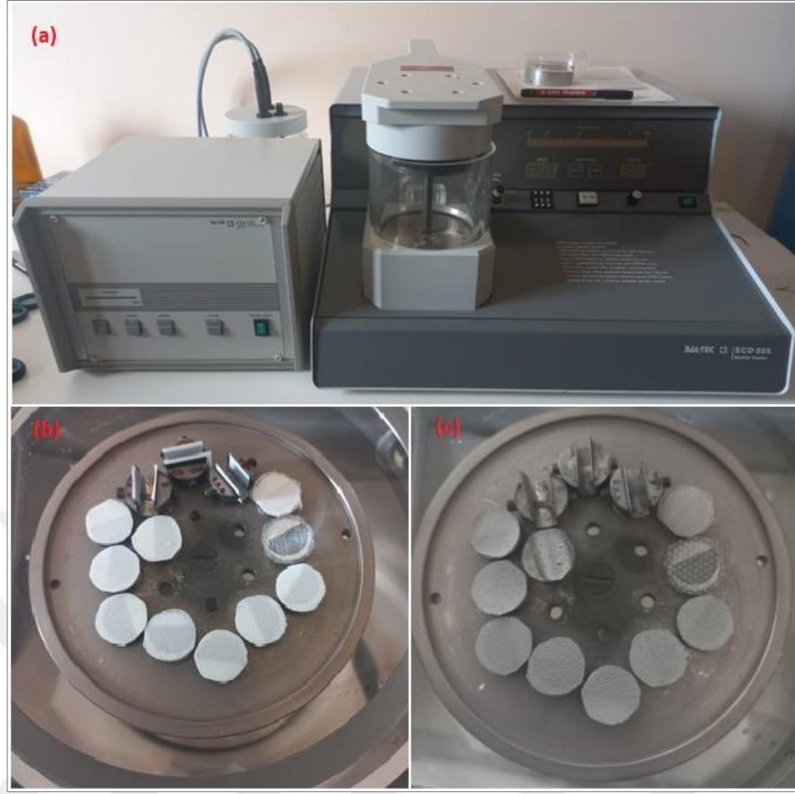
Şekil 3.21. SEM görüntüleme hazırlık işlemleri. (a) numune hazırlama cihazı (b) numuneler (c) altın-paladyum kaplanmış numuneler
