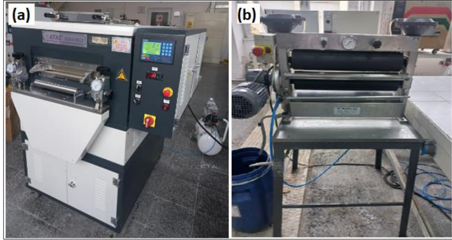
Şekil 3.2. (a) Laboratuvar tipi kaplama makinesi, (b) laboratuvar dikey tipi fular makinesi
