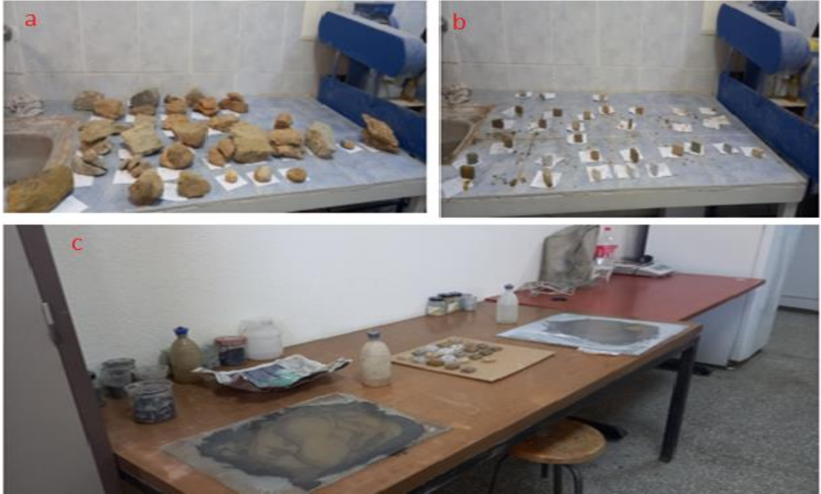
Şekil 3.4. İnceleme alanından alınan el örneklerinin laboratuvarında ince kesit yapımı için hazırlanması a) El örneklerinin alındığı lokasyon ve yerlerine göre sıralanması b) El örneklerinin küçük kare şeklinde kesilmesi c) Kare şeklinde kesilen el örneklerinin düzeltme diskinde inceltilerek pürüzsüz hale getirilmesi.
