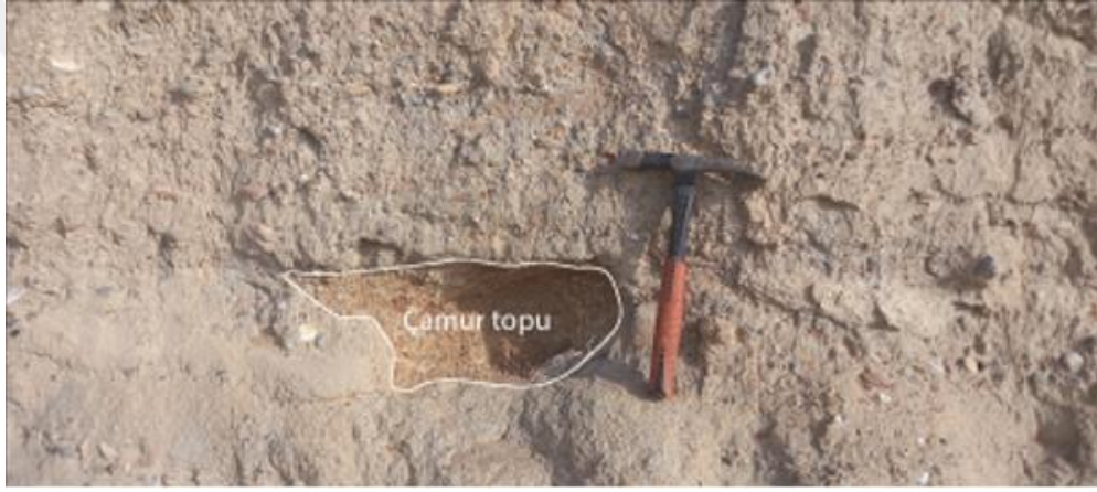
Şekil 5.35. Çakıllı-kaba taneli kumtaşı içerisinde gözlenen kırmızı renkli çamur parçacıkları (gecikme çökelleri). Gazenare Tepe kesiti (4. m)
