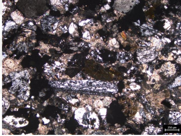
Şekil 5.65. Litarenit, metamorfik kayaç parçaları. (Cirban kesiti)
