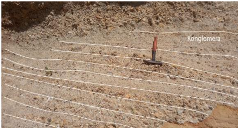
Şekil 5.30. Düzlemsel çapraz tabakalı konglomera. Atabağı kesiti (32-34 m)
