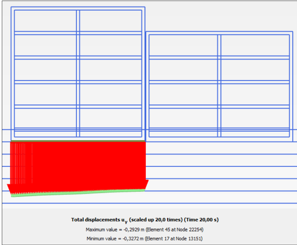
Şekil 7.118. Model-3 analiz sonucunda elde edilen H Blok oturma görünümü
