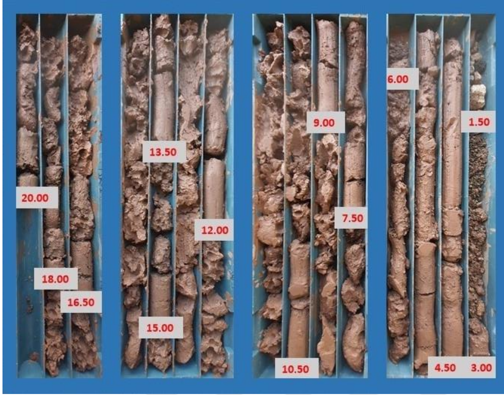
Resim 4.3. İSK1 sondajına ait sandık fotoğrafı
