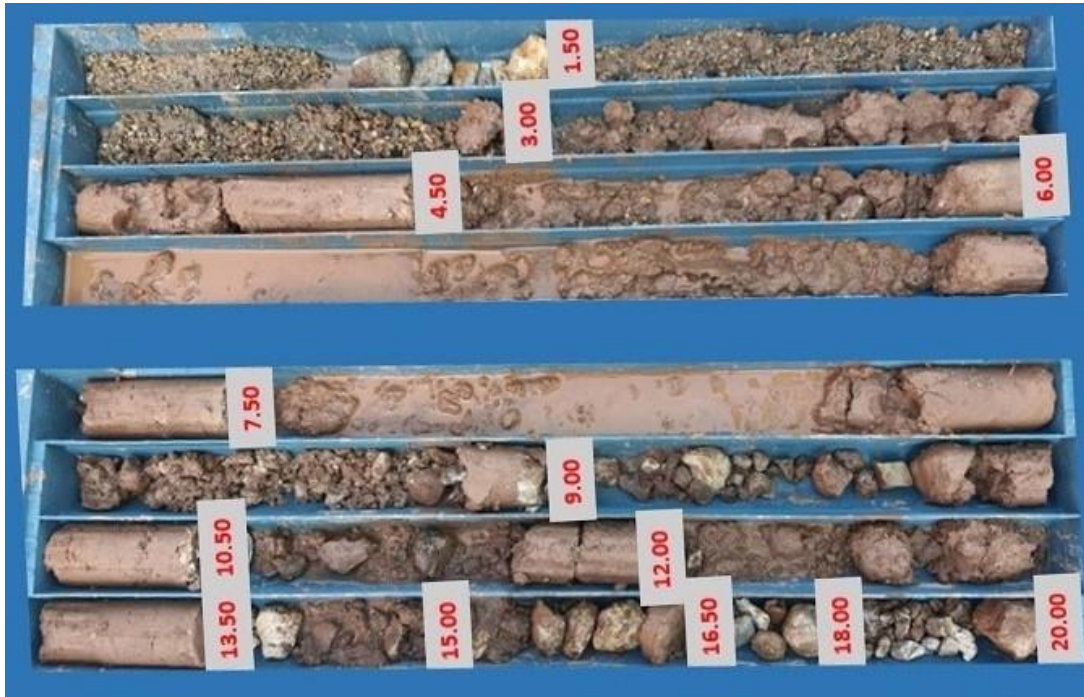
Resim 4.6. İSK-2 sondajı sandık fotoğrafı
