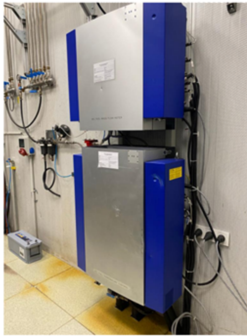
Şekil 4.5 Yakıt Sıcaklığı Şartlandırma ve Yakıt Tüketim Ölçüm Sistemi
