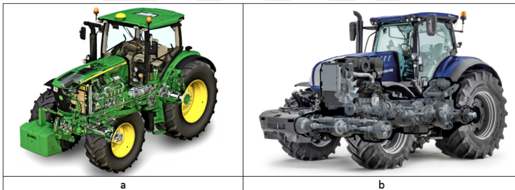
Şekil 2.7 a-) John Deere 6R Serisi Traktör Modeli. Traktör gücü 77-184 kW @ 2100 d/dk b-) New Holland T7 Serisi Traktör Modeli. Traktör gücü 92-221 kW @ 2200 d/dk
