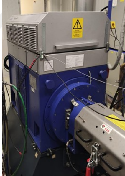
Şekil 4.3 AVL Dyno Road 402 Aktif Dinamometre
