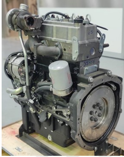
Şekil 4.11 3 Silindirli 75 BG İçten Yanmalı Dizel Motor
