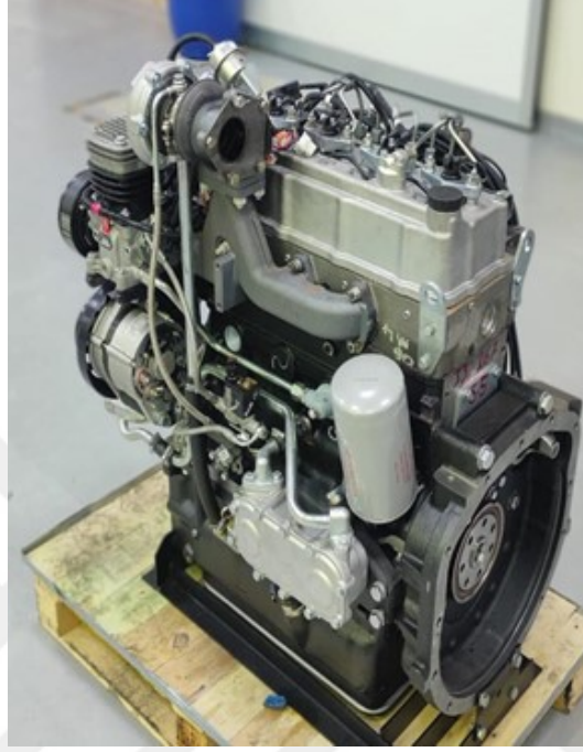
Şekil 4.8 4 silindirli 95 BG İçten Yanmalı Dizel Motor
