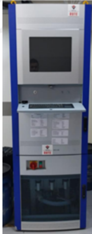
Şekil 4.7 AVL AMA i60 Egzoz Gazı Emisyon Ölçüm Cihazı
