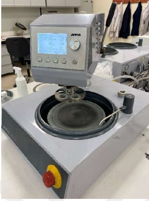
Şekil 3.8 : Zımparalama ve Parlatma İşlemlerinin Yapıldığı Cihaz (Solda) ile Dağlama İşlemleri Yapılmış Numuneler (Sağda).
