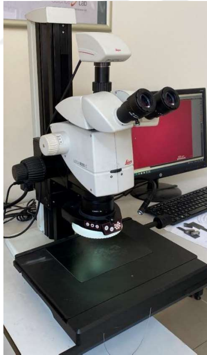
Şekil 4.25: Fotoğrafların Çekildiği Mikroskop (Leica M205 C).
