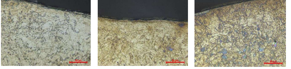
Şekil 4.33 : Soldan Sağa 10, 5 ve 9 Numaralı Gruptan Alınan Numunelerin Yüzeğe Yakın Bölgedeki Mikroyapı Görşelleri.
