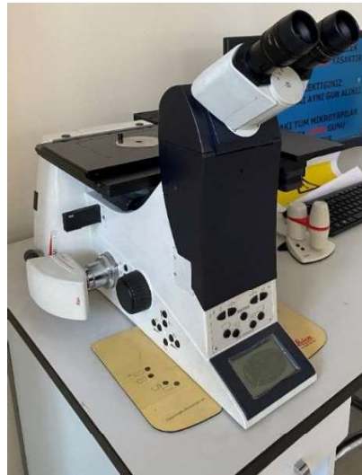
Şekil 4.29 : Mikroyapı Görsellerinin Alındığı Ters Mikroskop (Leica DMI 5000M).
