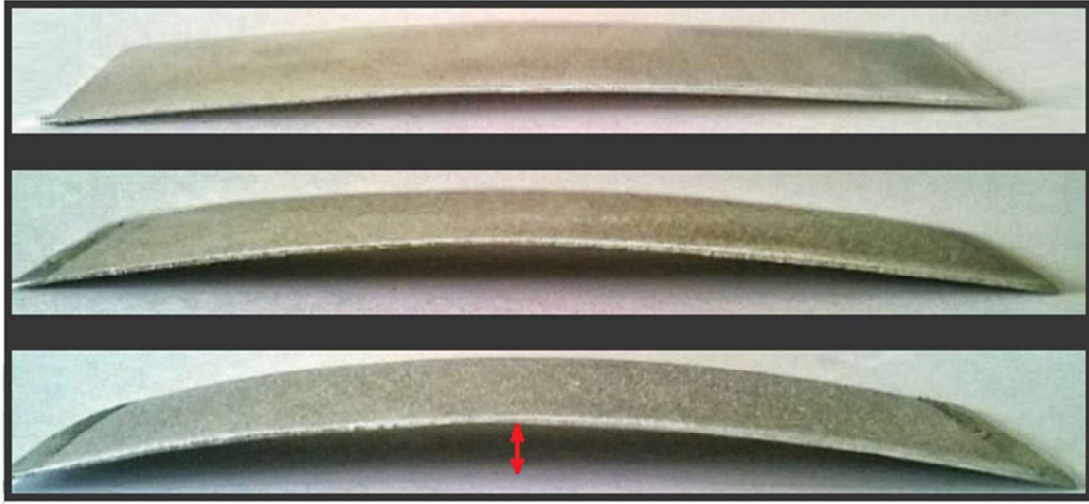
Şekil 2.6 : Farklı Sürelerde Bilyalı Dövme Uygulanmış Almen Plaklarda Oluşan Yay Formu ve Yoğunluğu İfade Eden Ölçünün Gösterimi.
