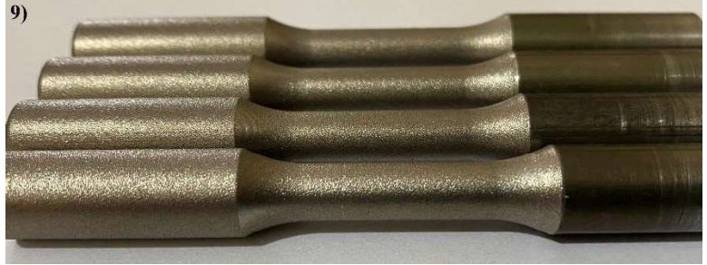
Şekil 3.6 : Bilyalı Dövme Uygulanan Numune Gruplarının Görselleri.
