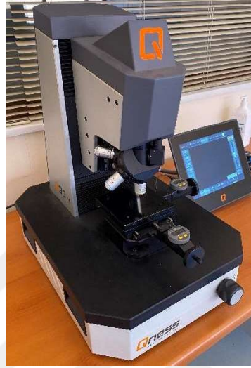
Şekil 4.18 : Mikrosertlik Ölçümlerinin Yapıldığı Cihaz (Qness Q30M).
