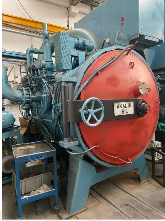
Şekil 3.2 : Uygulama Yapılan Ipsen Marka Isıl İşlem Fırını.
