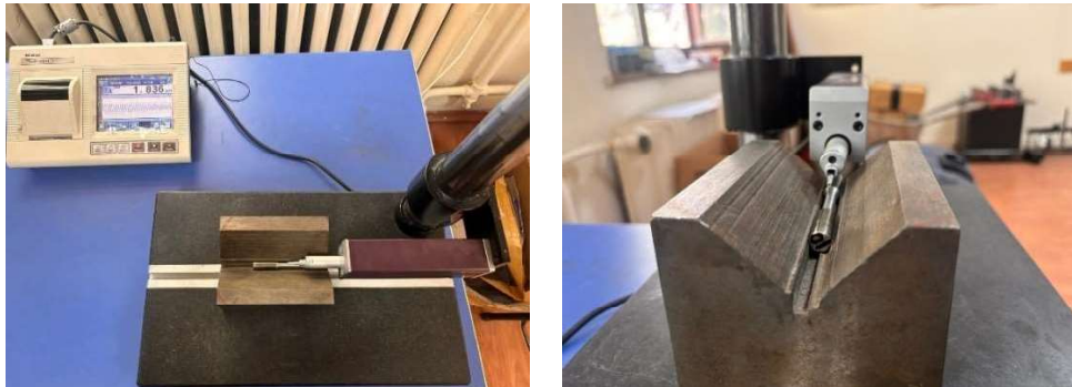
Şekil 4.20 : Yüzey Pürüzlülüğü Ölçümü.
