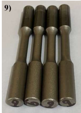
Şekil 3.6 : Bilyalı Dövme Uygulanan Numune Gruplarının Görselleri.
