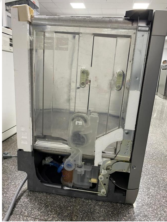
Şekil 3.6 Durum 1 Yalıtımsız olması durumu(Sağ) (Kişisel arşiv, 2025)
