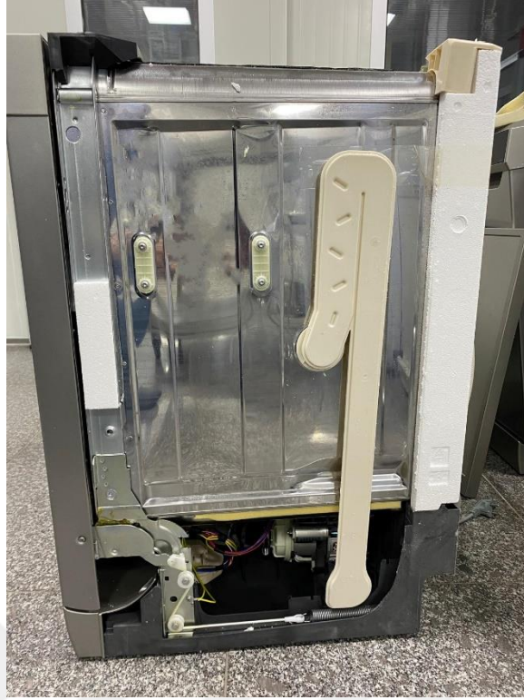
Şekil 3.5 Durum 1 Yalıtımsız olması durumu(Sağ) (Kişisel arşiv, 2025)
