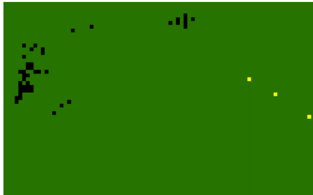
Şekil 4.8 : Kontrollü sınıflandırmada oluşan anlamsız pikseller (gürültü).
