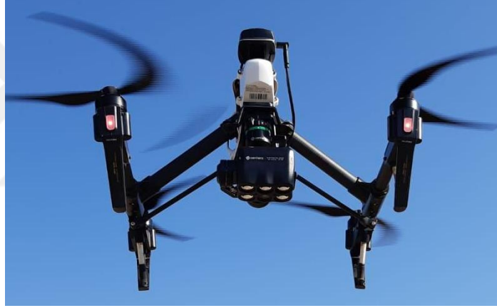
Şekil 1.1 : Üzerine multispektral kamera entegre edilmiş İHA.
