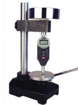
Şekil 4.6. Shore D sertlik cihazı.
