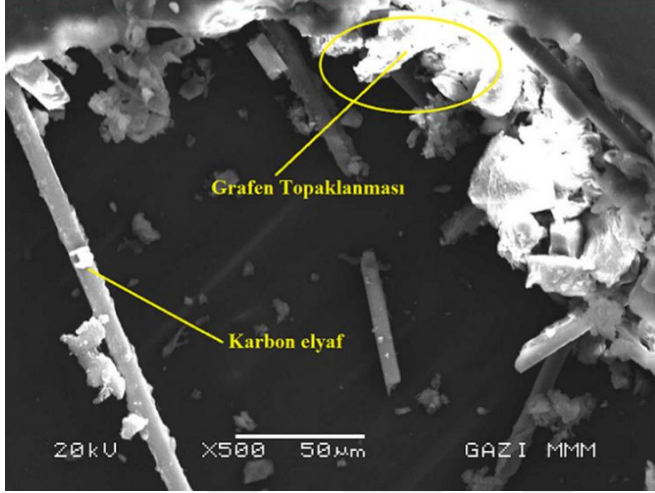
Resim 5.2. %0,5 GNP numunesine ait kırılma bölgesi SEM görüntüsü
