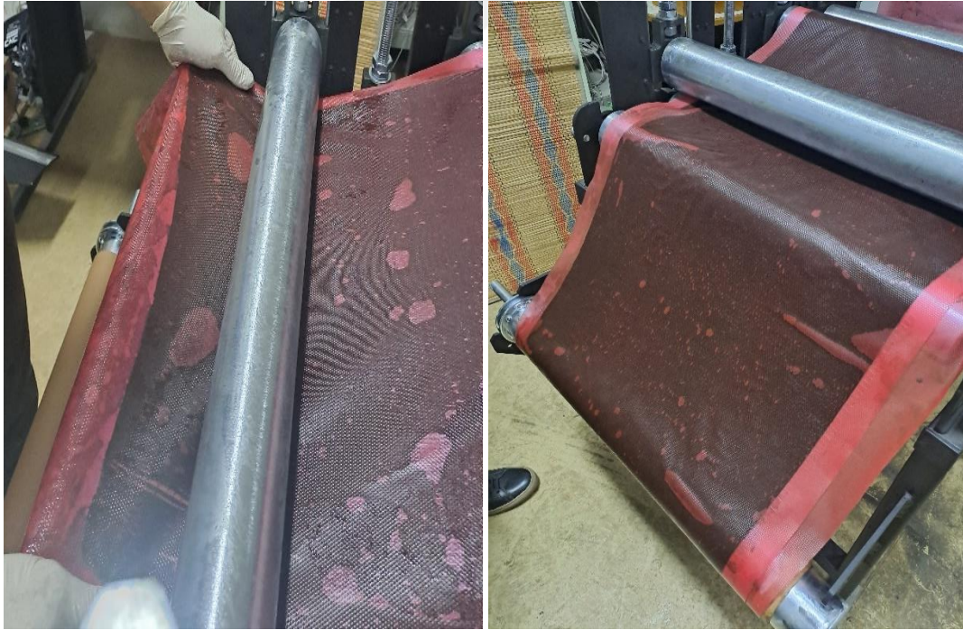
Resim 4.11. Islak karbon elyaf kumaşın sarım mandreline ulaşması
