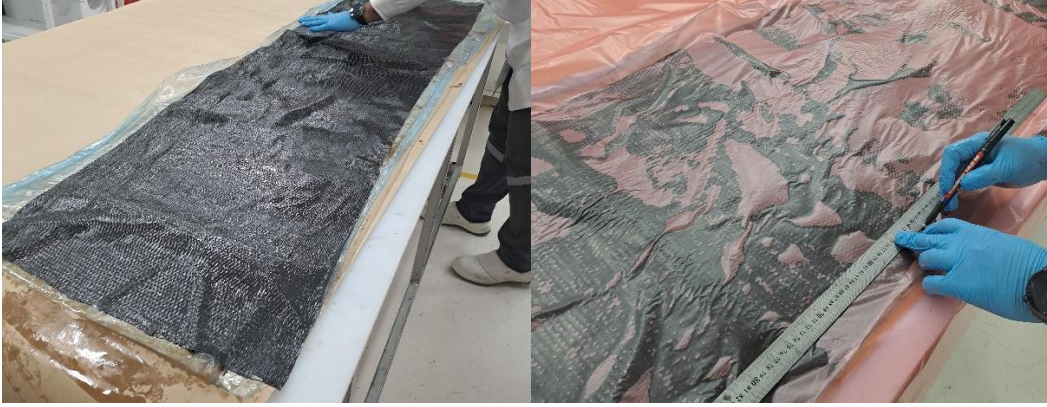
Resim 4.13. Prepeg numune serim için kesim işlemleri
