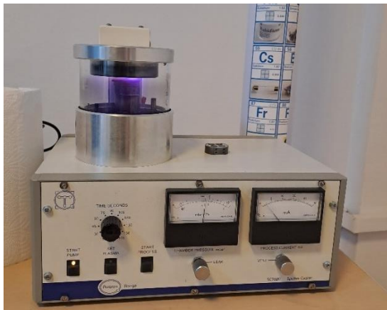
Resim 5.1. Au-Pd kaplama cihazı
