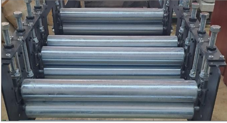
Resim 4.1. Çift mandrelli sıkıştırma sistemleri
