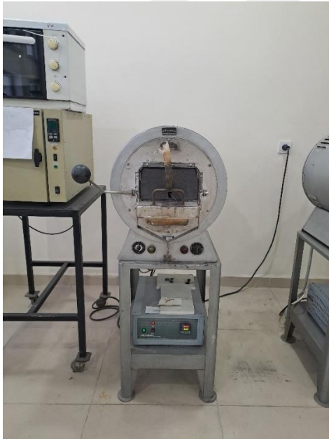
Resim 4.21. Kül fırınında yakma işlemi
