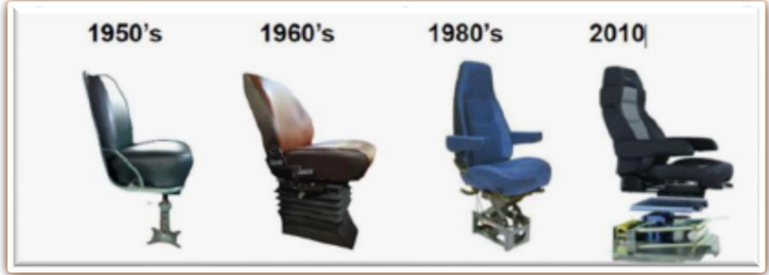
Şekil 1.4. Yıllara göre farklı koltuk süspansiyon türleri (Mayton vd., 2019)
