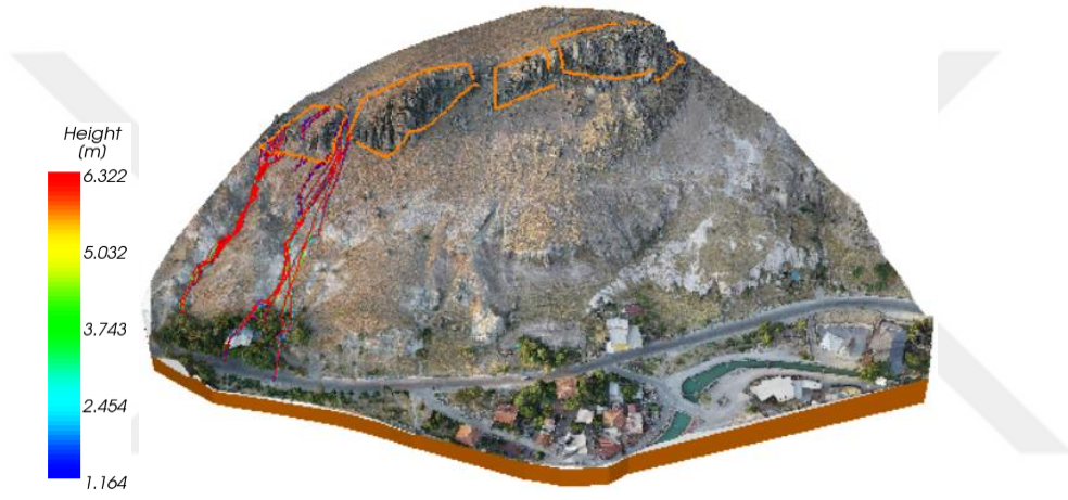
Şekil 120. 4. Bölge için 3D kaya düşme analizi sonucu hesaplanan sıçrama yüksekliği değerleri
