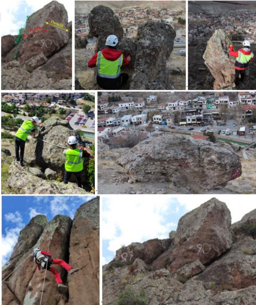
Şekil 58. Gözlemsel yüzey incelemesi ve riskli blok tespit çalışmalarına ait bazı görüntüler.
