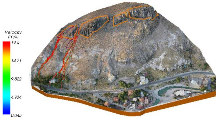
Şekil 121. 4. Bölge için 3D kaya düşme analizi sonucu hesaplanan hız değerleri
