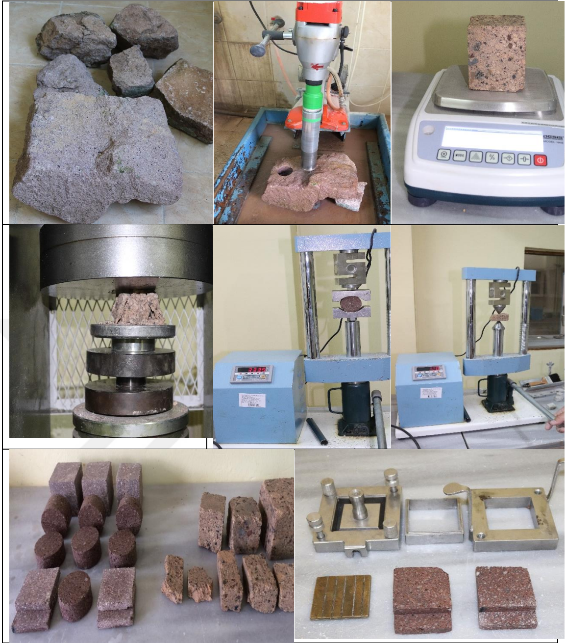
Şekil 38. İnceleme alanından derlenen blok örneklerinin laboratuvarında deney standartlarında hazırlanması ve bazı jeomekanik deneyler
