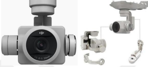
Şekil 23. Phantom 4 PRO tipi Dynamica insansız hava aracı kamerası
