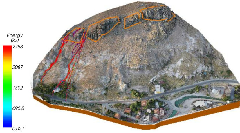
Şekil 122. 4. Bölge için 3D kaya düşme analizi sonucu hesaplanan kinetik enerji değerleri
