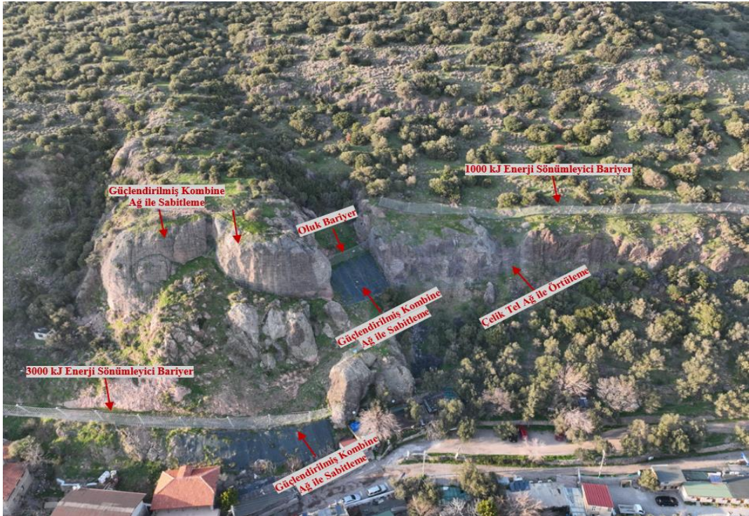
Şekil 17. Birleşik koruma yönetimlerinin uygulandığı kaya ıslahı projesi (Nasery vd., 2024)
