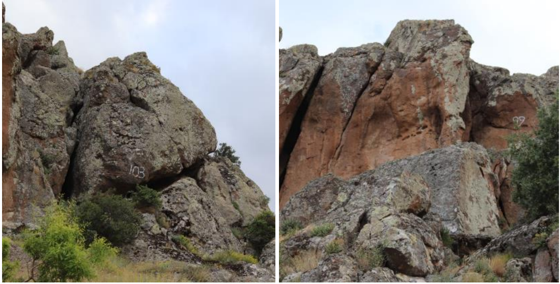
Şekil 64. Düşme süreci kestirilemez durumdaki blokların görüntüleri
