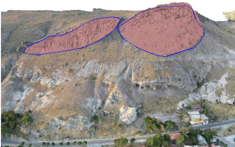
Şekil 154. Andezitik tüf biriminde bulunan kontrollü kırım uygulaması önerilen bölgelerin sınırları
