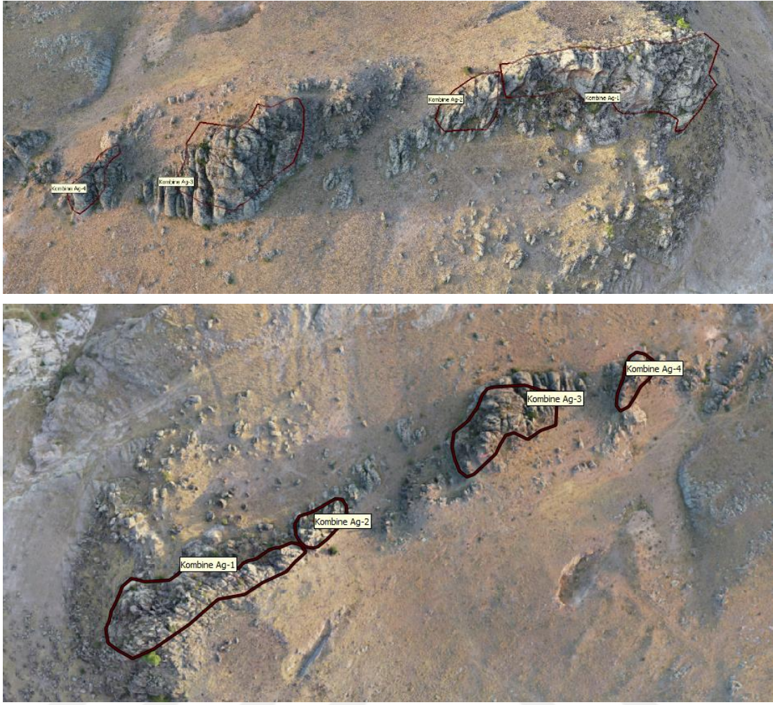
Şekil 155. Andezitik tuf biriminde güçlendirilmiş kombine ağ uygulaması önerilen bölgeler
