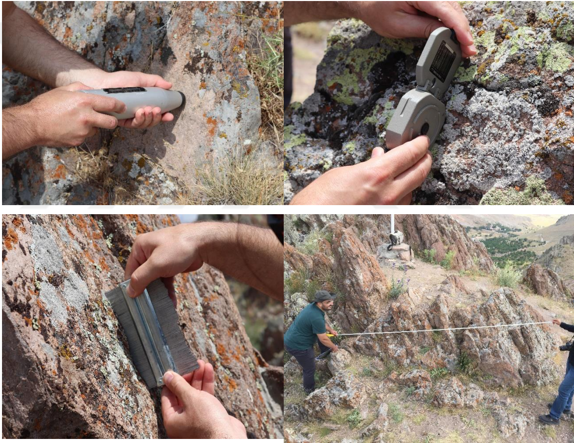
Şekil 39. İnceleme alanında hat etüdü çalışmaları ve süreksizlik özelliklerinin belirlenmesi
