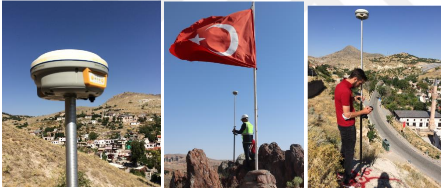
Şekil 21. CORS (SATLAB S1500) GNSS alıcısı cihazı ve YKN ölçümleri
