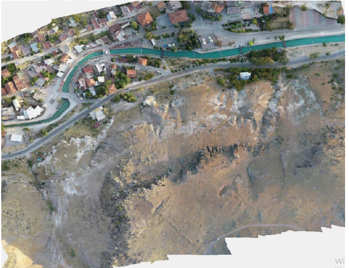
Şekil 28. 2.89 cm/pix hassasiyetinde oluşturulan ortofoto
