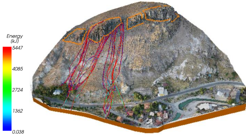
Şekil 119. 3. Bölge için 3D kaya düşme analizi sonucu hesaplanan kinetik enerji değerleri
