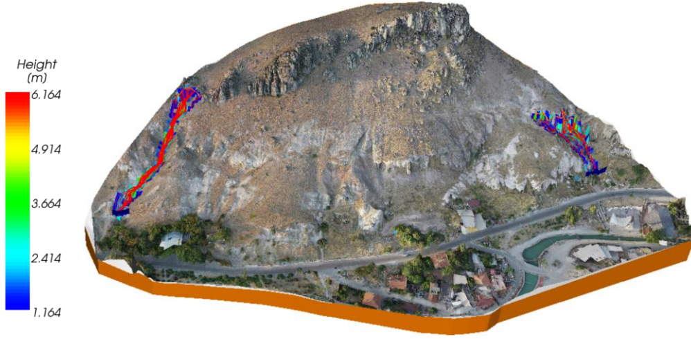
Şekil 180. Oluk bariyerlerin yerleştirilmesi sonrasında yapılan 3D kaya düşme analizi ile elde edilen sıçrama yüksekliği değerleri
