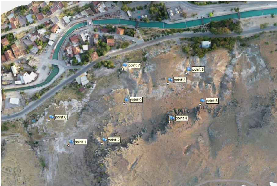
Şekil 19. Yer kontrol noktalarının arazi üzerindeki dağılımı
