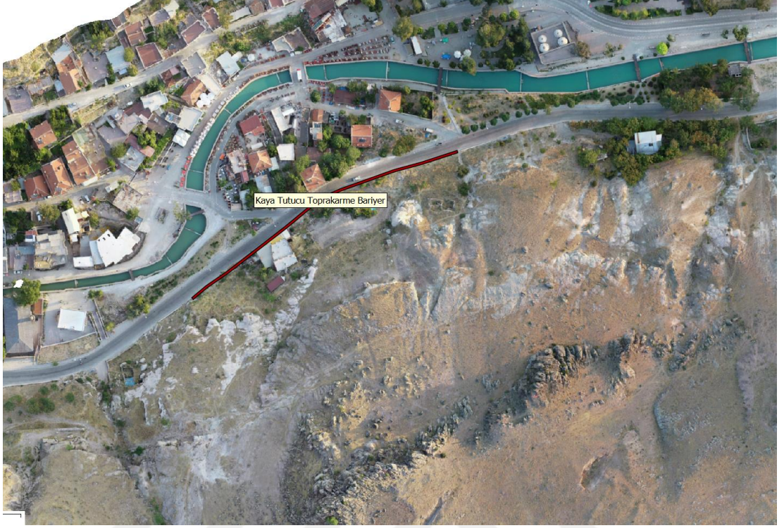
Şekil 156. Kaya tutucu toprakarme bariyerin 3D model üzerindeki şematik görünümü
