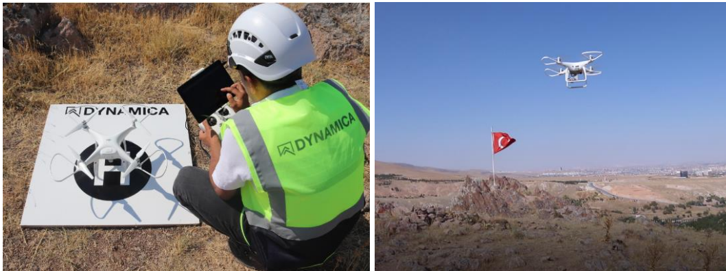
Şekil 24. 4 pervaneli Phantom 4 Pro tipi Dynamica insansız hava aracı ile fotogrametrik çekim
