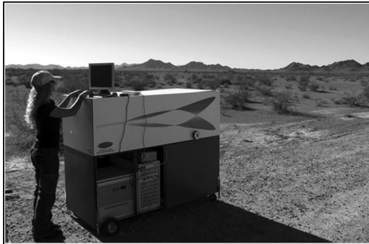
řekil 2.19: Patlayıcı tespiti iin kullanılan arabaya monte edilmiř ara LIBS aleti [117].
