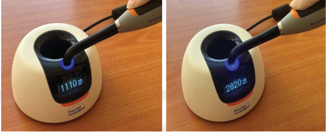
Şekil 17. Radyometre (Bluephase Meter, Ivoclar, Lichtenstein) ile LED ışık cihazının ışınım şiddetinin ölçümü
