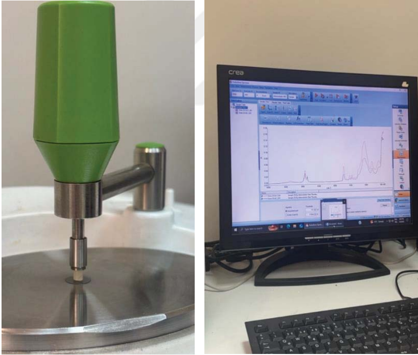
Şekil 20. Kompozit rezın örneklerin FTIR ile spektral ölçümlerinin alınması
