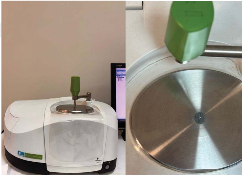
Şekil 13. FTIR-ATR cihazı (Perkin Elmer Spectrum Two, Waltham, ABD)
