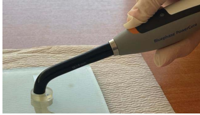
Şekil 18. Kompozit rezin örneklerin polimerize edilmesi
