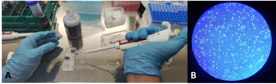
Şekil 3.6. A. Steril tam yalıtımlı kabinde thoma lam yardımıyla hücre sayımı, B. Thoma lamında alanlarda L929 fibroblast hücre sayımı (4x)
