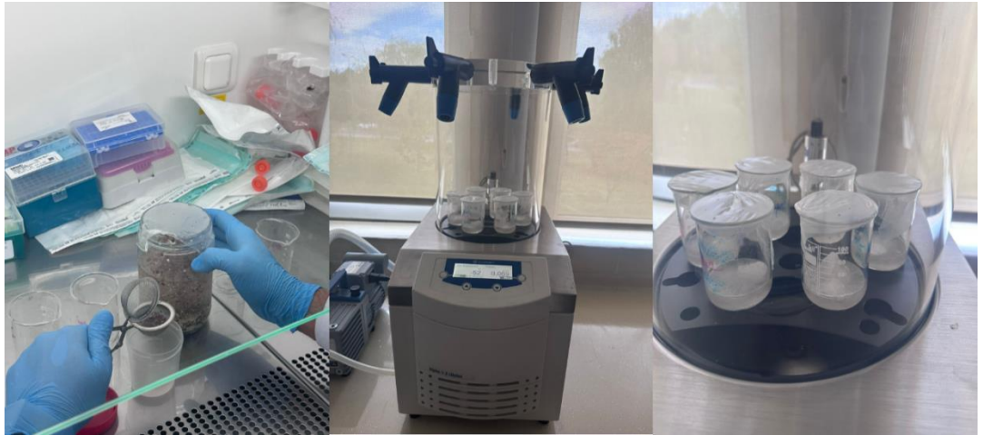
Şekil 3.4. İn vitro ortamda kullanılan ayva çekirdeği musilajının liyofilizatörde kurutma işlemi
