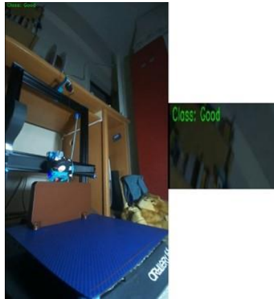
Görsel 6.8. Gerçek zamanlı test ortamı “Hatasız baskı” (Good) sınıfına ait örnek çıktı
