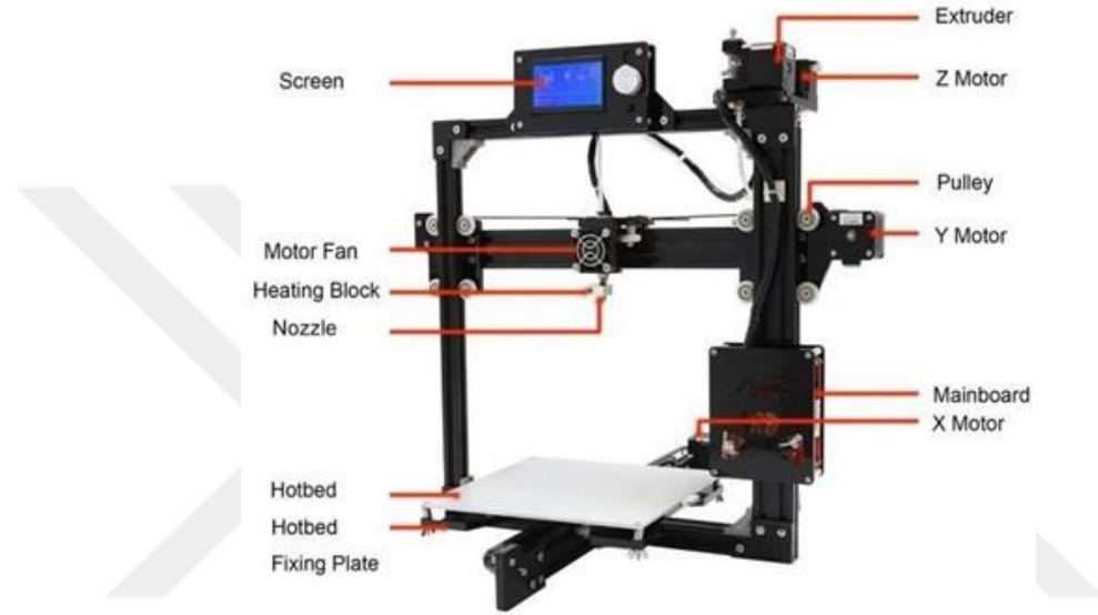
Şekil 2.5. FDM tipi 3D yazıcıların donanımsal bileşenleri (Prianto & Pramono, 2021)
