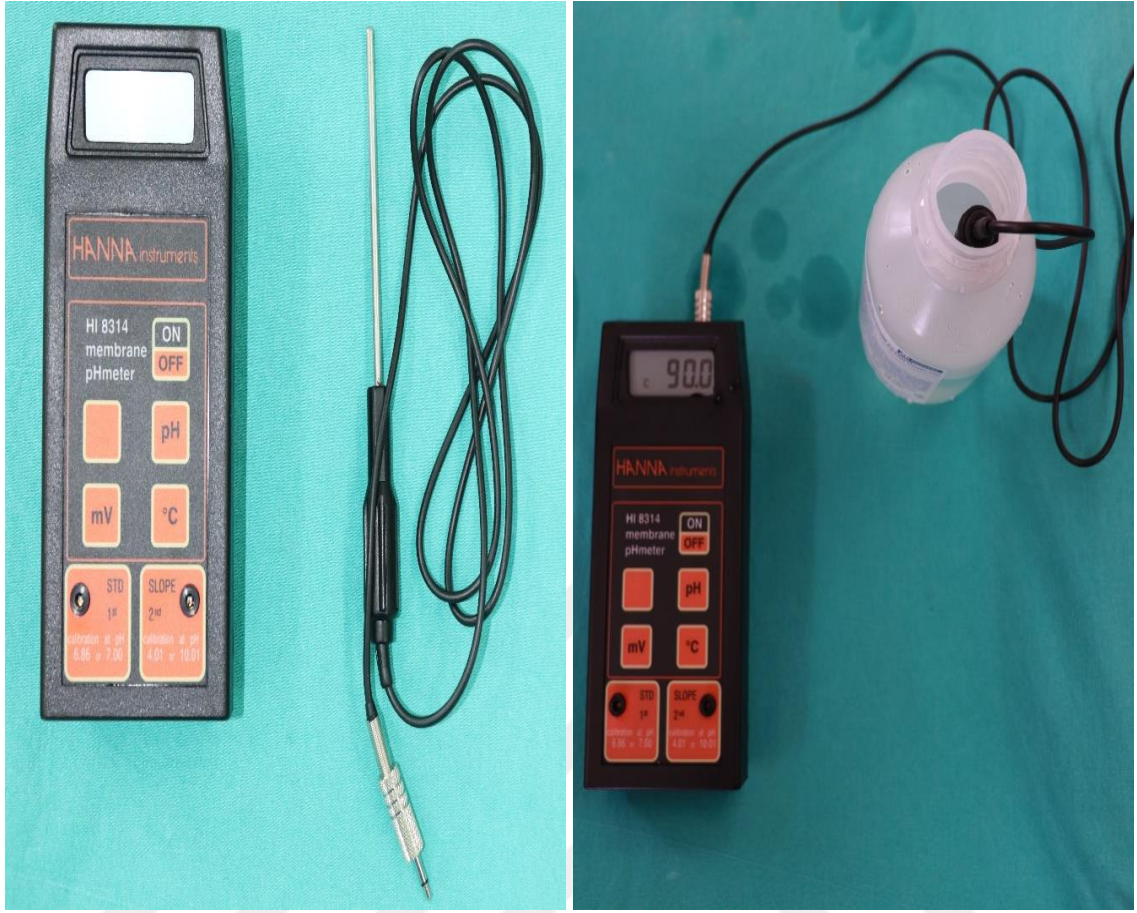
Şekil 13. Suyun sıcaklığını ayarlama için kullanılan termometre ve suyun sıcaklığını ayarlamaya bir örnek
