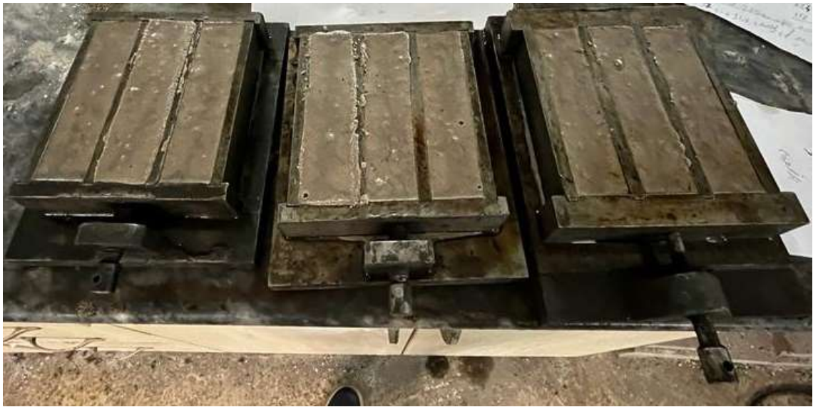
Şekil 2.3. Hamur numunelerin kalıplara yerleştirilmesi
