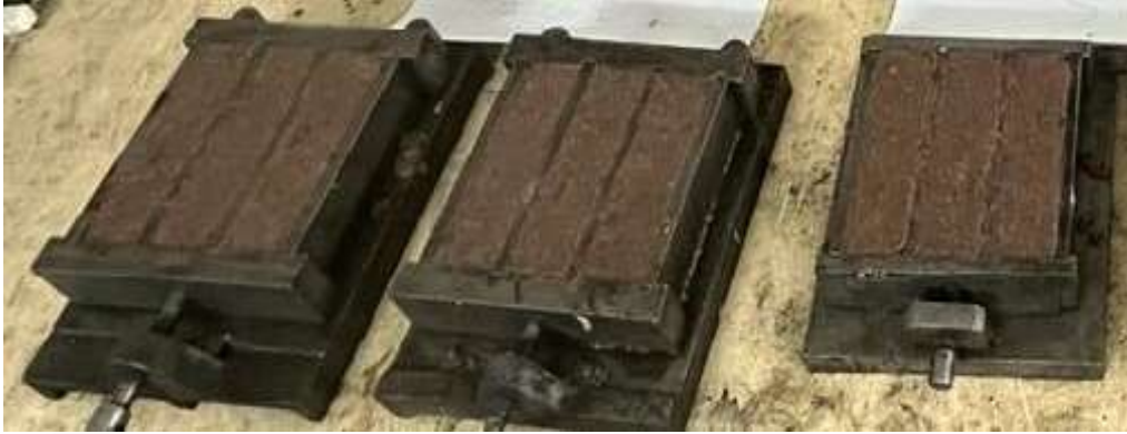
Şekil 2.4. Harç numunelerin kalıplara yerleştirilmesi
