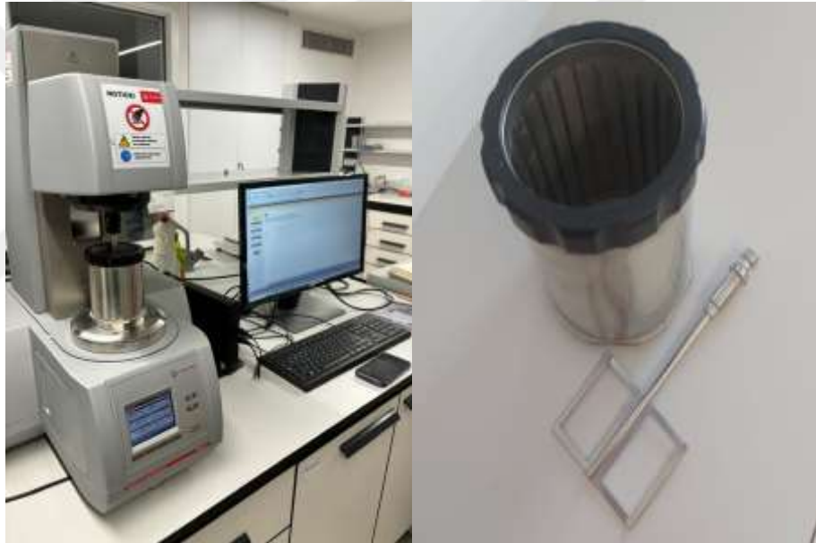
Şekil 2.8. Reometre cihazı, ölçüm kabı ve karıştırıcı başlık
