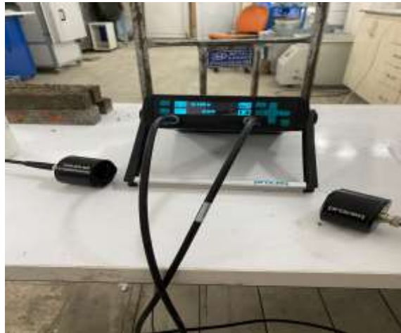
Şekil 2.5. Ultrasonik atımlı dalga hızının belirlenmesi
