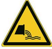
W055 - Uyarı Kanalizasyon atık su çıkışı
