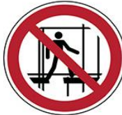
P025 - Bu tamamlanmamış iskeleyi kullanmayın
