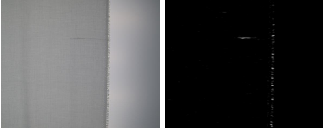
Şekil 3.16 : Hatalı kumaş ve gabor filtresi uygulanmış görüntüsü (3).
