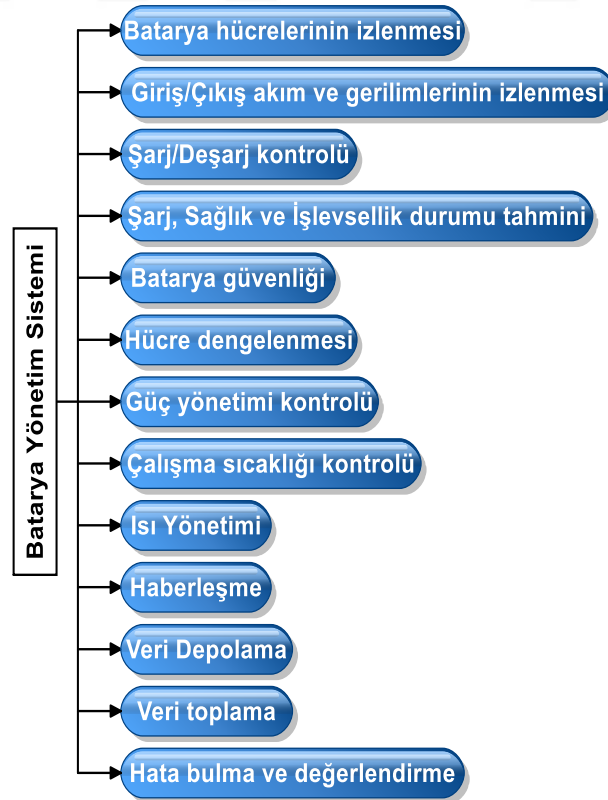
Şekil 3.1 : Batarya yönetim sistemi işlevleri
