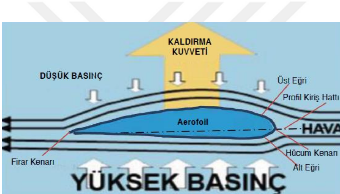
Şekil 2.9. Havanın aerofoil etrafındaki hareketi ve kaldırma kuvveti oluşumu
