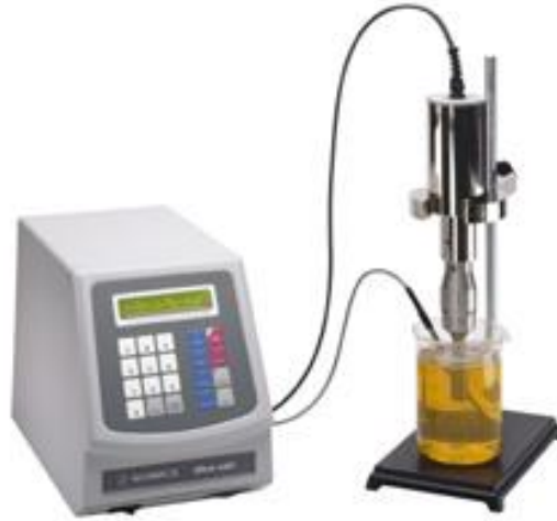
Şekil 3.1: Ultrason Destekli Ekstraksiyon’da kullanılan SONICS VCX 750 marka sonikatör cihazı.
