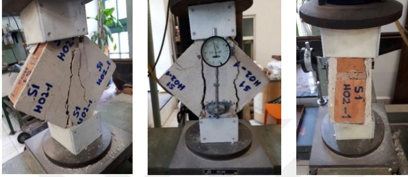
Şekil 6.9 : Donatısız horasan harcı ile çift taraflı güçlendirilen hasarsız model tuğla duvarın göçme şekli.
