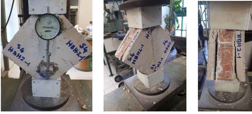
Şekil 6.21 : Bazalt mesh donatılı horasan harcı ile çift taraflı güçlendirilen hasarlı model tuğla duvarın göçme şekli.
