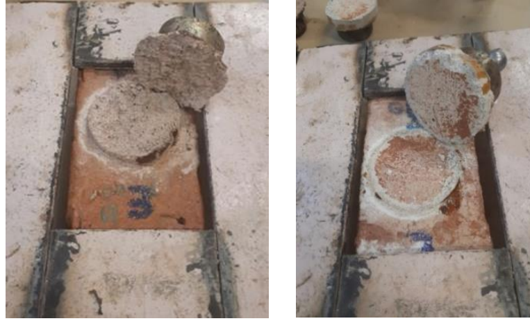
Şekil 4.13 : Aderans deneyi sonucunda harçların kopma biçimleri.
