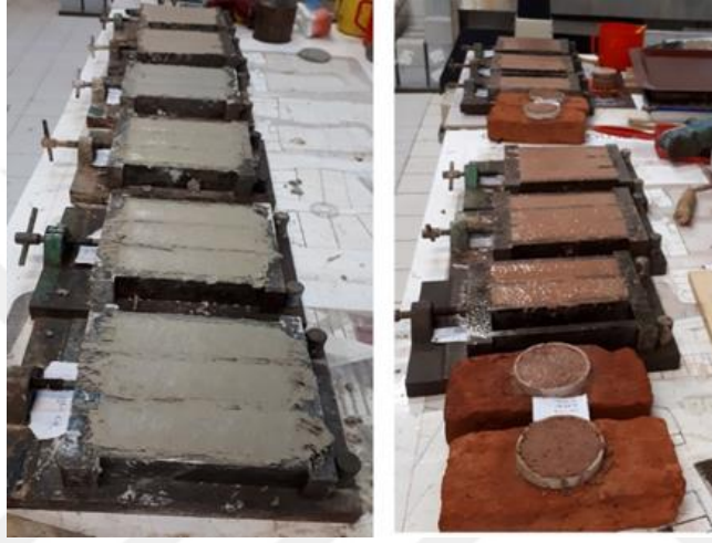
Şekil 4.3 : Örgü ve Güçlendirme harçlarının kalıplanması.
