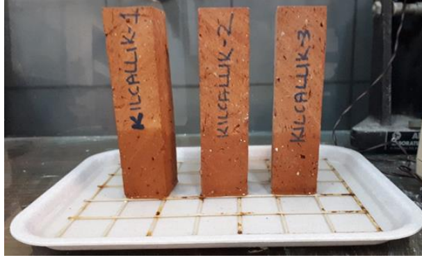
Şekil 3.1 : Harman tuğlasına kılcal etkiye bağlı su emme deneyinin uygulanması.
