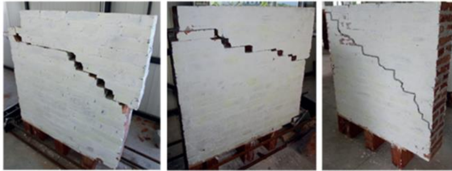
Şekil 2.2 : Diyagonal basınç deneyi uygulanmış yalın duvar numuneleri (Mustafaraj ve Yardım, 2017).
