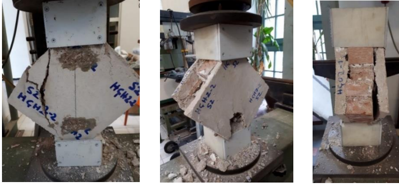
Şekil 6.13 : Çelik hasır donatılı horasan harcı ile çift taraflı güçlendirilen hasarlı model tuğla duvarın göçme şekli.
