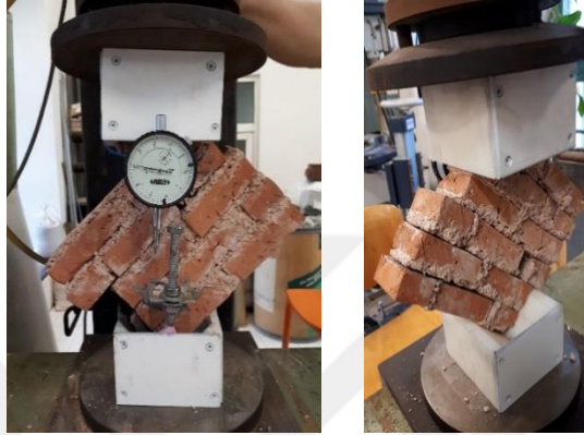
Şekil 6.7 : Yalın model tuğla duvarın göçme şekli.
