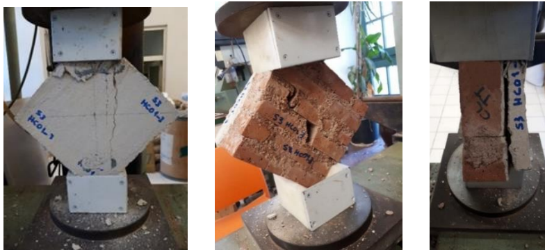
Şekil 6.14 : Cam lifi tekstil donatılı horasan harcı ile tek taraflı güçlendirilen hasarsız model tuğla duvarın göçme şekli.
