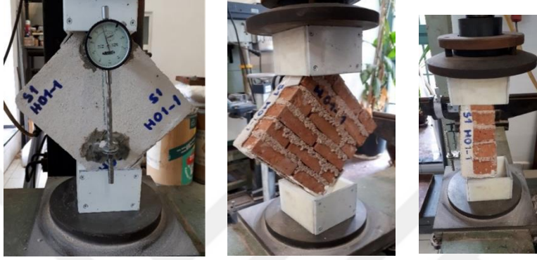
Şekil 5.22 : Donatısız horasan harcı ile tek taraflı güçlendirilen model tuğla duvar numunelerine diyagonal basınç deneyi uygulanması.
