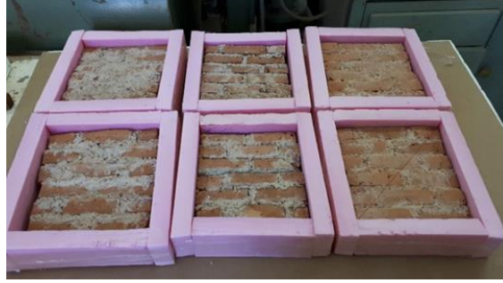
Şekil 5.17 : Model tuğla duvarların kalıplanması.
