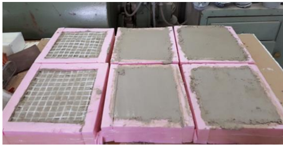
Şekil 5.20 : Model tuğla duvarların cam lifi tekstil donatılı horasan harcı ile güçlendirilmesi.
