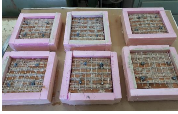
Şekil 5.19 : Çelik hasır donatılıların model tuğla duvarlara ankrajlanması.
