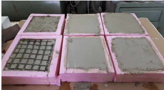
Şekil 5.21 : Model tuğla duvarların bazalt mesh donatılı horasan harcı ile güçlendirilmesi.
