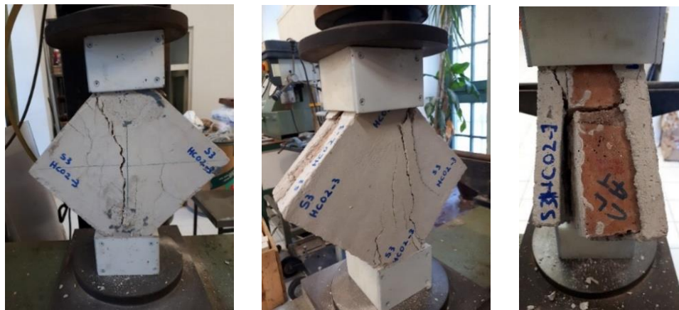
Şekil 6.16 : Cam lifli tekstil donatılı horasan harcı ile çift taraflı güçlendirilen hasarsız model tuğla duvarın göçme şekli.
