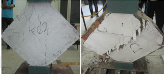
Şekil 2.7 : Ferrocement harç ile güçlendirilen tuğla duvar numunelerine diyagonal basınç deneyi uygulanması (Yardim ve Lalaj, 2016).
