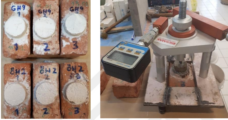
Şekil 4.12 : Harçlara çekme deneyi uygulanması.
