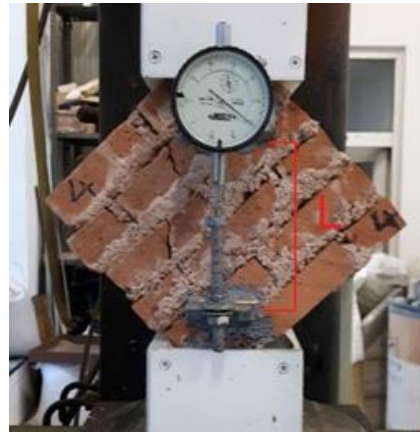
Şekil 5.8 : Numunelerin yer değiştirme ölçümünün yapıldığı dikey uzunluk.
