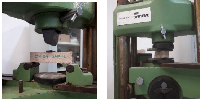
Şekil 4.4 : Eğilme ve basınç dayanım deneyi uygulaması.
