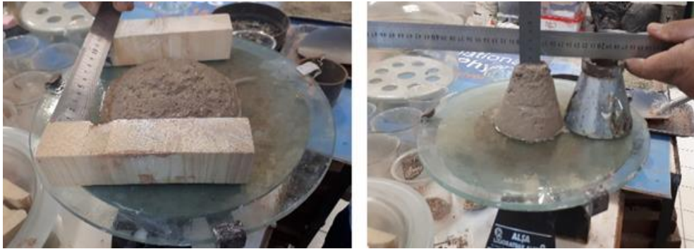
Şekil 4.2 : Güçlendirme harcına yayılma deneyi uygulanması.
