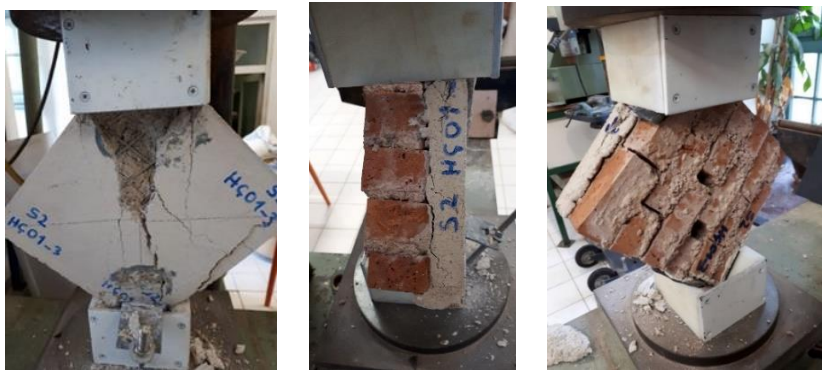
Şekil 6.10 : Çelik hasır donatılı horasan harcı ile tek taraflı güçlendirilen hasarsız model tuğla duvarın göçme şekli.
