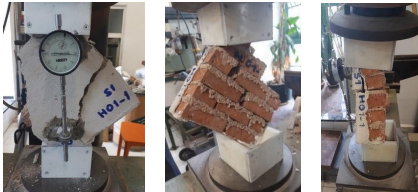
Şekil 6.8 : Donatısız horasan harcı ile tek taraflı güçlendirilendirilen hasarsız model tuğla duvarın göçme şekli.
