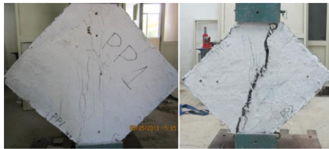
Şekil 2.8 : Polipropilen katkılı harç ile güçlendirilen tuğla duvar numunelerine diyagonal basınç deneyi uygulanması (Yardim ve Lalaj, 2016).
