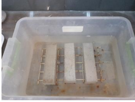
Şekil 4.9 : Harç numunelerine atmosfer basıncı altında su emme deneyinin uygulanması.
