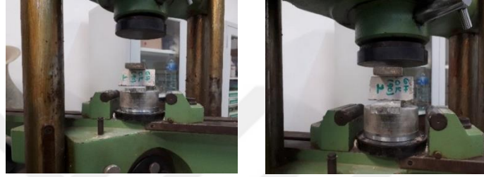
Şekil 4.11 : Basınç dayanım deneyinin uygulanması.
