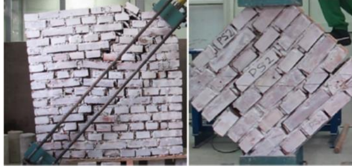
Şekil 2.4 : Yalın tuğla duvar numunelerine diyagonal basınç deneyi uygulanması (Yardim ve Lalaj, 2016).
