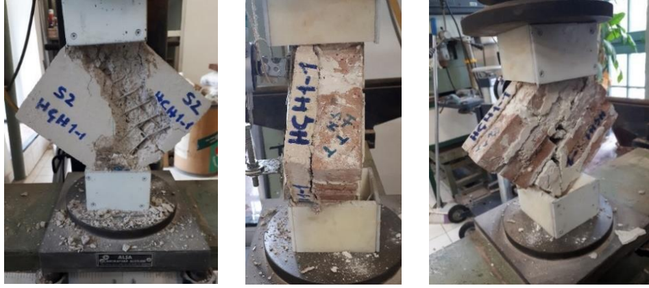
Şekil 6.11 : Çelik hasır donatılı horasan harcı ile tek taraflı güçlendirilen hasarlı model tuğla duvarın göçme şekli.
