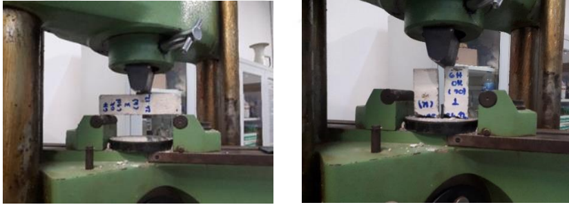
Şekil 4.10 : Eğilme deneyinin uygulanması.
