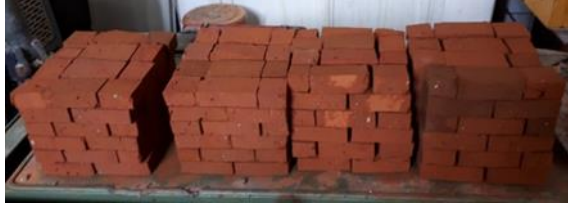
Şekil 5.2 : Elmas testere ile kesilen model tuğlalar.
