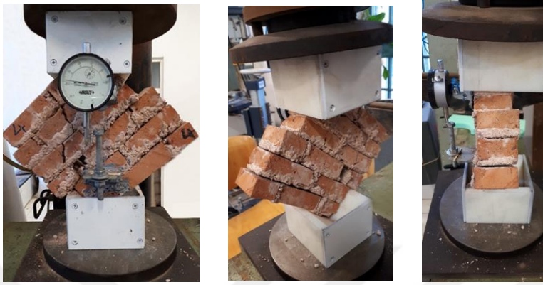
Şekil 5.15 : Diyagonal basınç deneyi sonucunda hasar gören yalın tuğla duvar.
