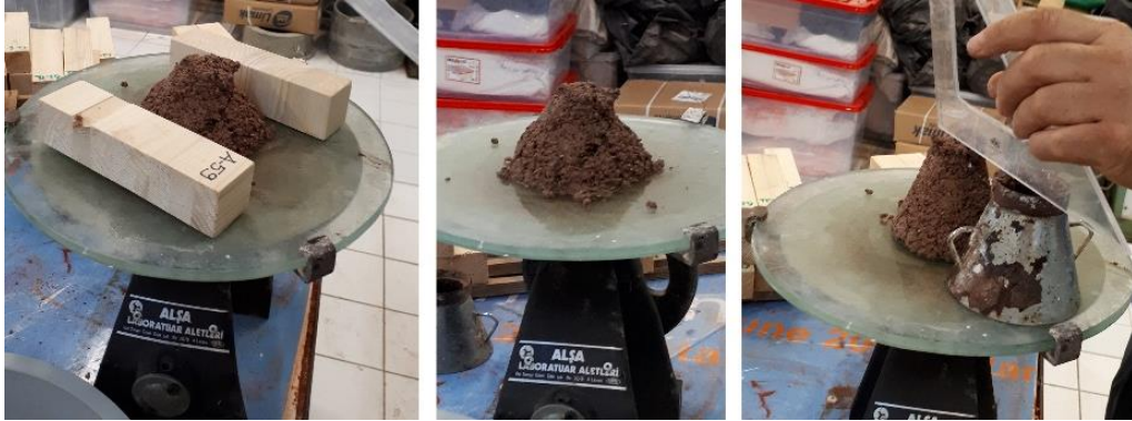
Şekil 4.1 : Örgü harcına yayılma deneyi uygulanması.
