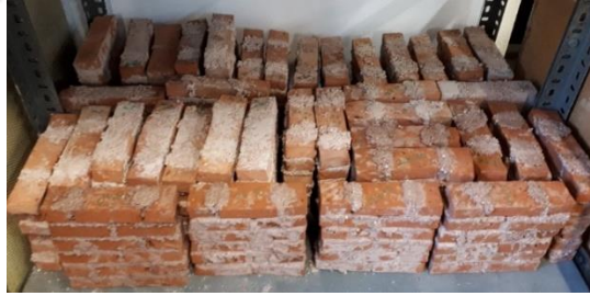
Şekil 5.3 : Üretilen model tuğla duvarlar.
