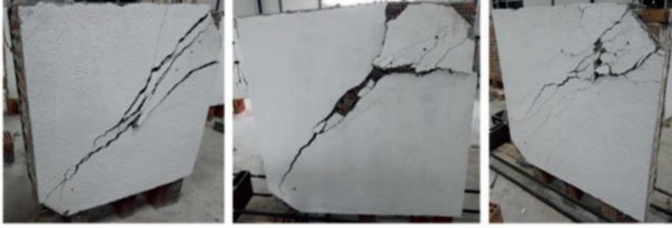
Şekil 2.3 : Diyagonal basınç deneyi uygulanan güçlendirilmiş tuğla duvar numuneleri (Mustafaraj ve Yardım, 2017).
