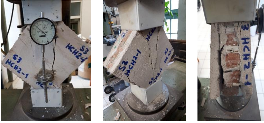
Şekil 6.17 : Cam lifi tekstil donatılı horasan harcı ile çift taraflı güçlendirilen hasarlı model tuğla duvarın göçme şekli.
