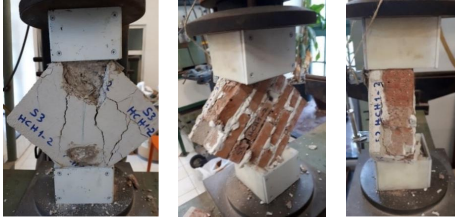
Şekil 6.15 : Cam lifli tekstil donatılı horasan harcı ile tek taraflı güçlendirilen hasarlı model tuğla duvarın göçme şekli.
