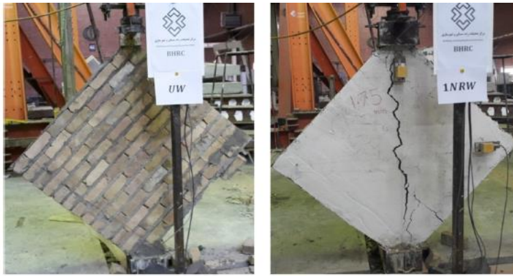
Şekil 2.1 : Diyagonal basınç deneyi uygulaması (Shabdin ve diğ, 2018).
