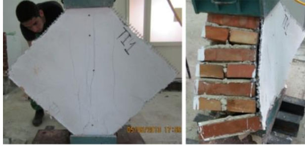
Şekil 2.6 : TRM ile tek taraflı güçlendirilen tuğla duvar numunelerine diyagonal basınç deneyi uygulanması (Yardim ve Lalaj, 2016).
