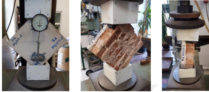
Şekil 5.25 : Çelik hasır donatılı harç ile güçlendirilen model tuğla duvar numunesine diyagonal basınç deneyi uygulanması.
