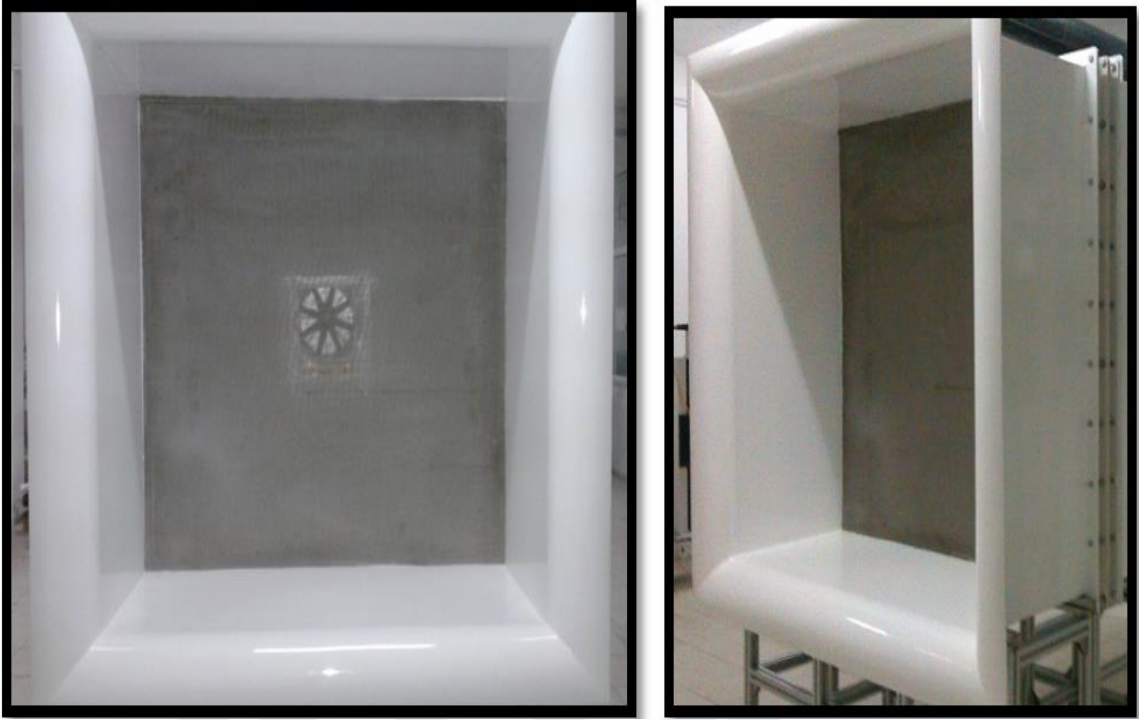
Şekil 2. 8. Rüzgar tüneli giriş bölümü ve akış düzenleyici elek flanşlarının görünümü [51]
