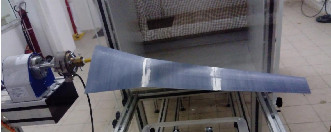
Şekil 2. 14. AR=10.32 açıklık oranlı kanat modelinin rüzgâr tüneline sabitlenmiş görüntüsü
