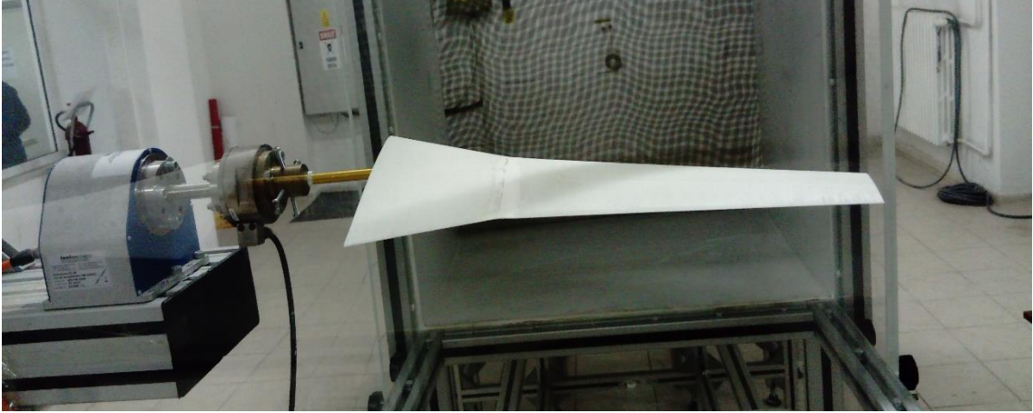
Şekil 2. 13. AR=7.94 açıklık oranlı kanadın rüzgar tüneline sabitlenmiş görüntüsü
