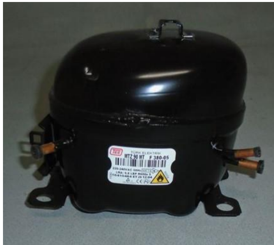
Şekil 4.1 Tezgah seviyesi buzdolabında kullanılan kompresör.
