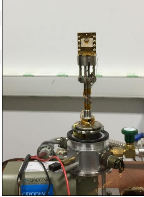
Resim 6.6. Elektriksel ölçüm için örnek tutucuya yerleştirilmiş numune
