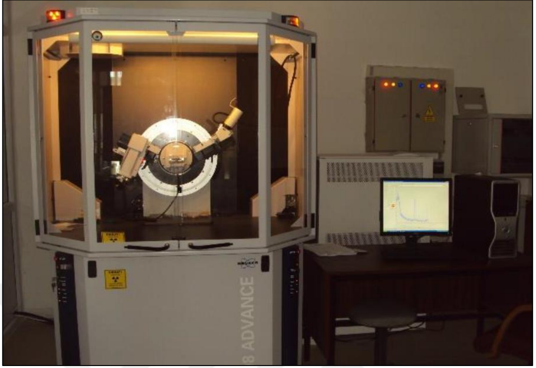
Resim 6.4. XRD analizinde kullanılan Bruker D8 Advance model X-ışınları difraktometresi
