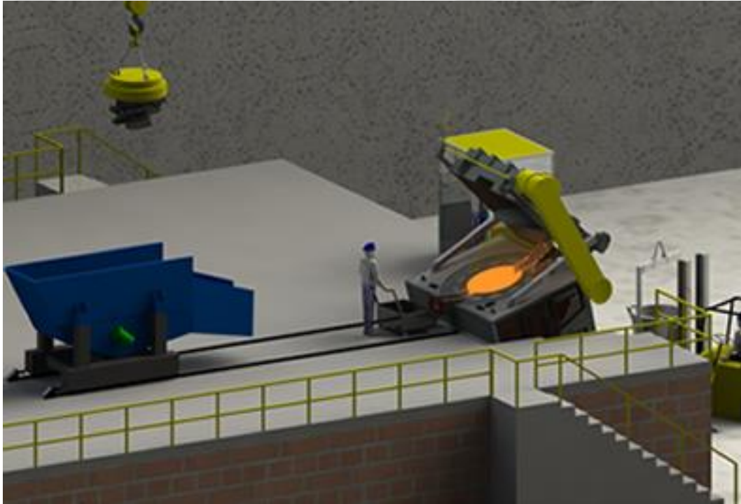
Şekil 7. İndüksiyon ocağına sarsak ile metal (Ç1 piki ve çelik gibi) şarjının şematik görünümü
