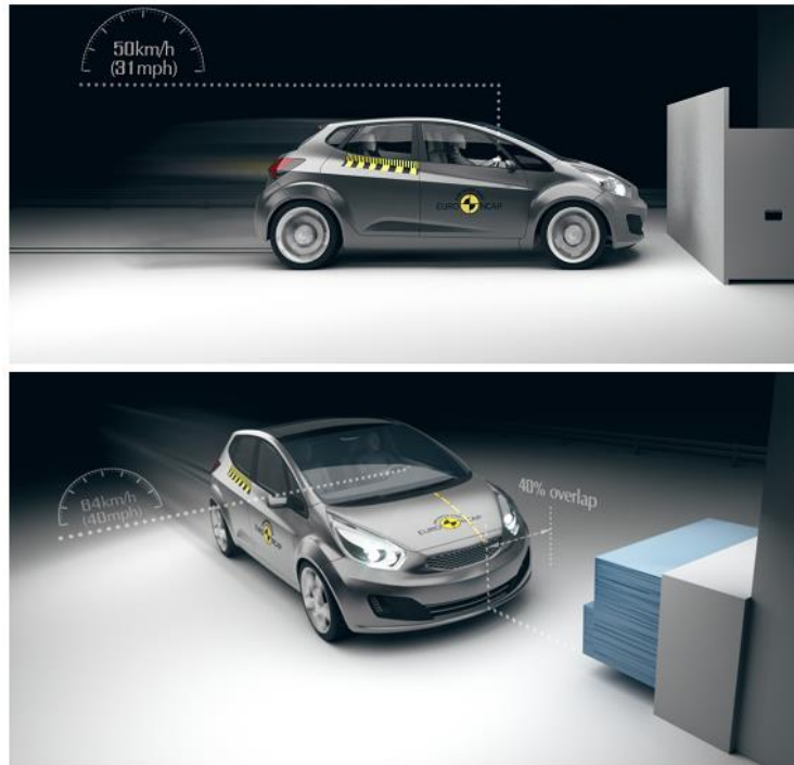
Şekil 4.1. Taşıt önden çarpma testleri [27].
