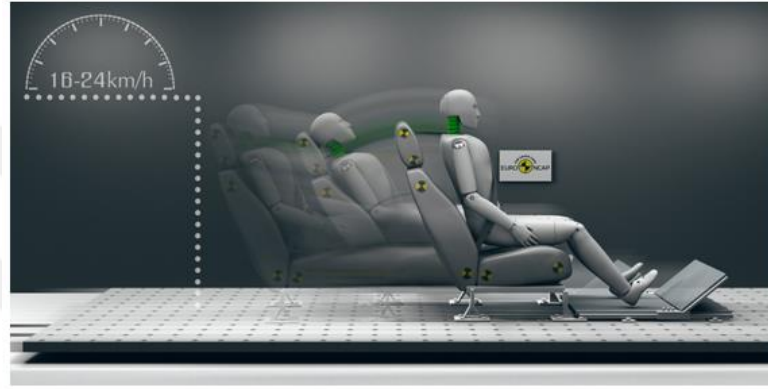
Şekil 4.3. Boyun koruma testi [27].
