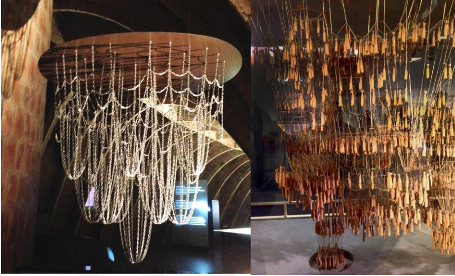
Şekil 2.1: Gaudi'nin üç boyutlu asılı zincir modelleri.
