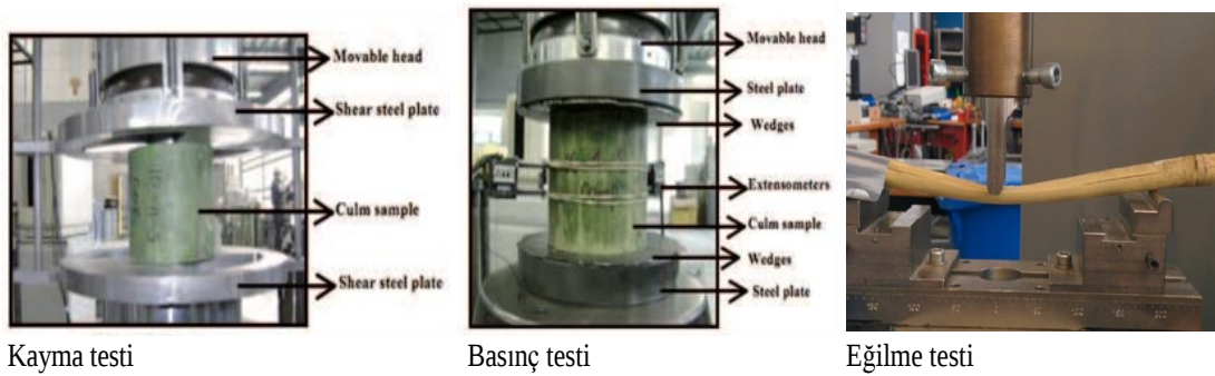
Şekil 3.6: Bambu kayma (shear), baskı (compression) (Correal D & Arbeláez C, 2010), eğilme (bending) testleri (Url-3).
