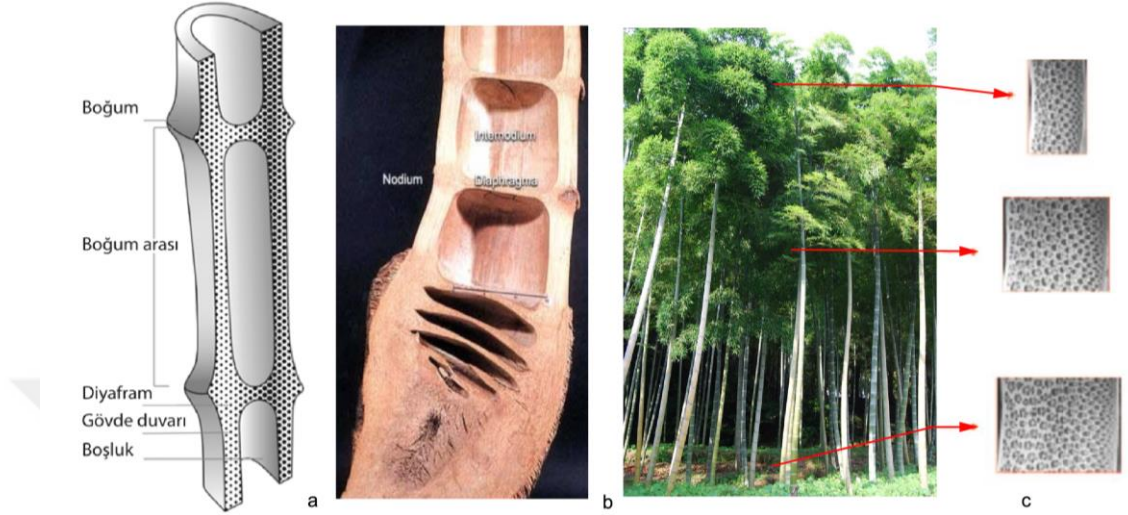
Şekil 3.9: a) Bambu enine kesit detayı. b) Gövdesi boyunca değişen lif yoğunluğu. c) Bambu en kesiti (Erdine, 2015; Lee ve diğ, 2010).
