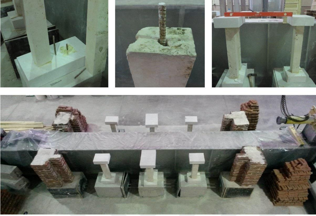
Şekil 6.9 Mermerlerin yerleştirilmesi ve bağlantı şekli.
