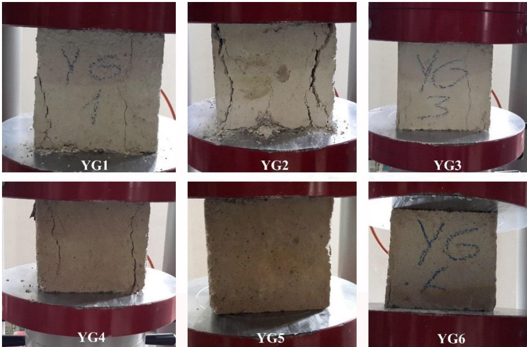
Şekil 6.20 Tek eksenli basınç deneyi altında harç numunelerinde oluşan çatlaklar.
