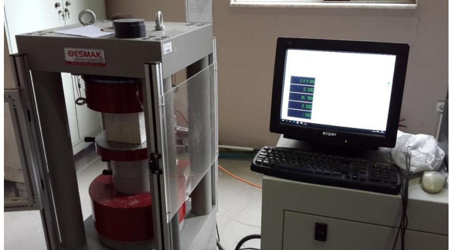
Şekil 3.8 Tek eksenli basınç deneyi cihazı.
