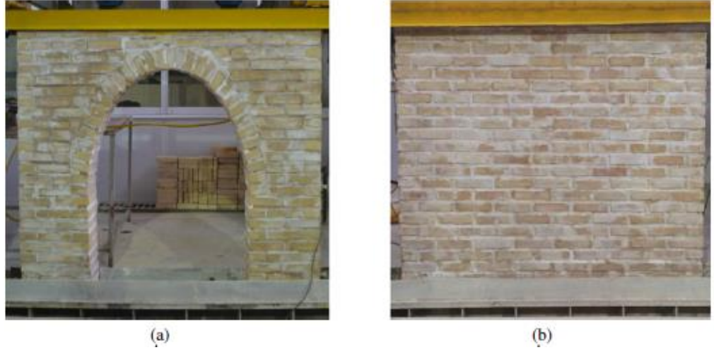
Şekil 2.2 Deney yapıları a) Kemer b) Dolu duvar (Karimi et. al., 2016)
