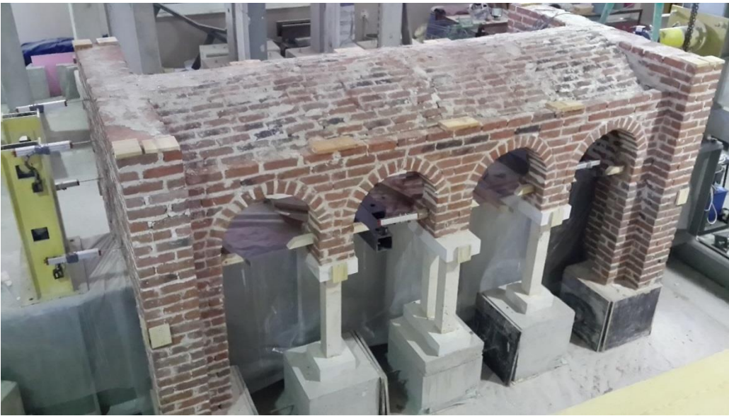
Şekil 6.33 Potansiyometrelerin gergisiz yapı üzerine yerleştirilmiş hali.
