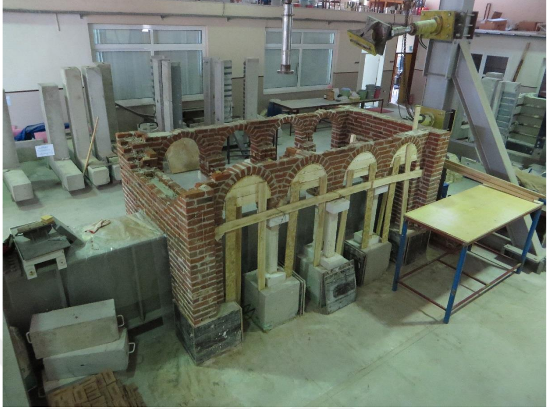
Şekil 6.14 Uzun doğrultudaki kemerlerin tamamlanmış hali.
