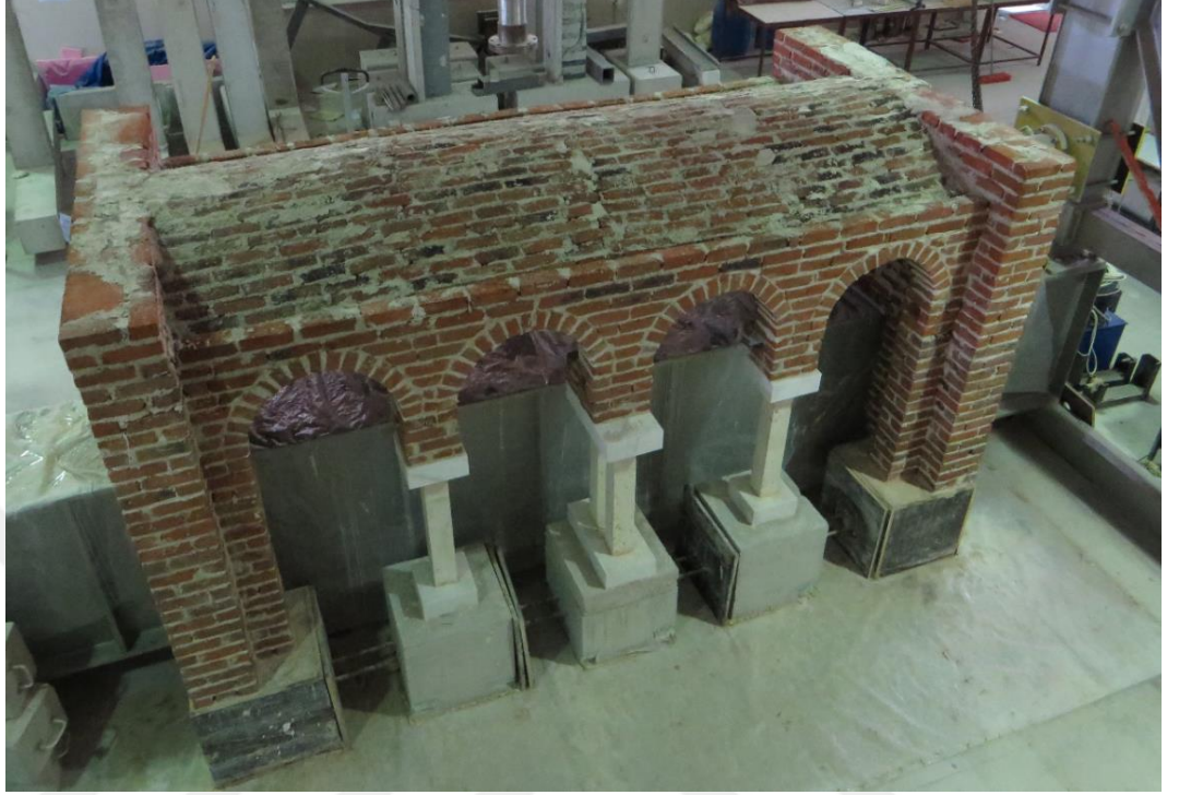
Şekil 6.18 Gergisiz deney yapısının son hali.
