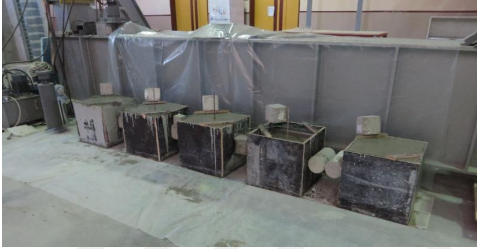
Şekil 6.6 Temel kalıp yerleşimi ve beton dökümü sonrası.
