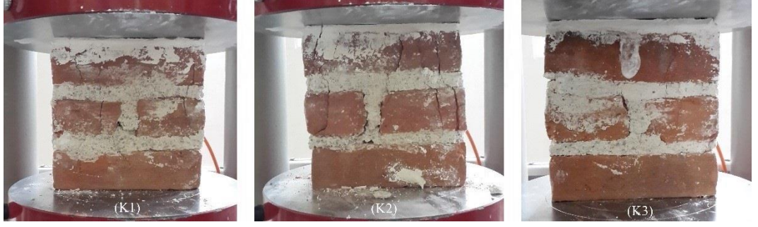
Şekil 6.27 Tek eksenli basınç deneyi altında tuğla duvar (3 sıra) numunelerinin üzerinde oluşan çatlaklar.
