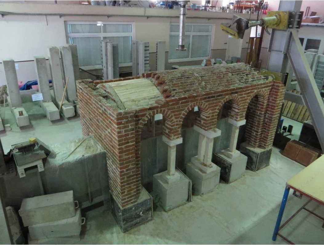
Şekil 6.17 Yapının tonoz kısmının oluşturulması.
