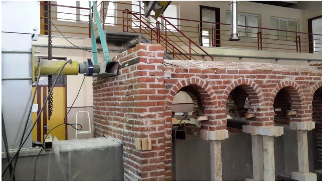
Şekil 6.31 Yapıya uygulamam yükleme şekli.
