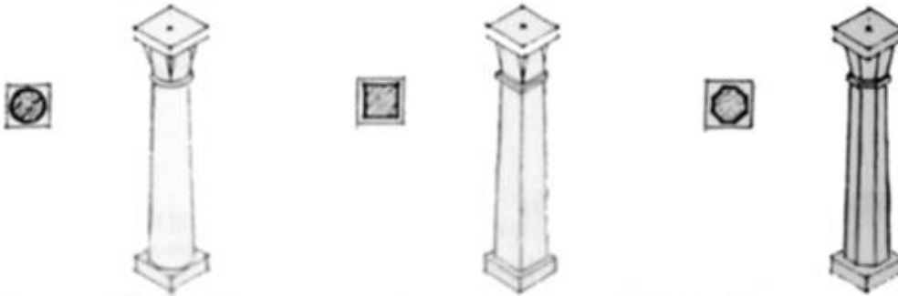
Şekil 3.9 Geometrik şekillerine göre sütun elemanlar (Tuluk, 1999).
