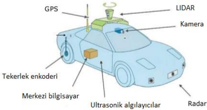
Şekil 1.8 : Otonom araç donanımı [9].
