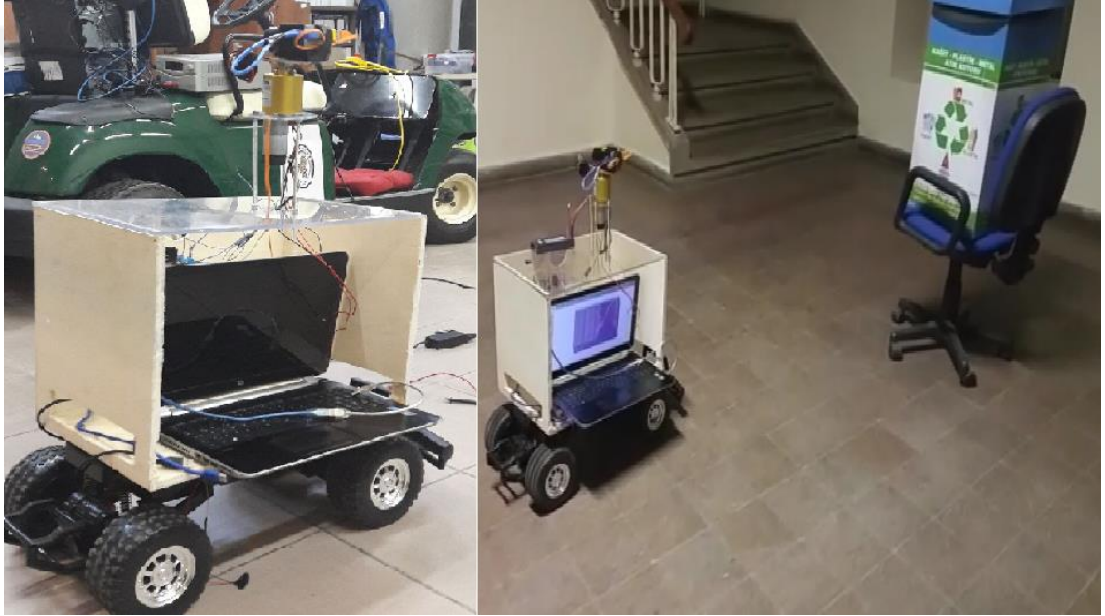
Şekil 4.22: Hareketli sistemde engel tespiti deneyinde kullanılan mobil araç.
