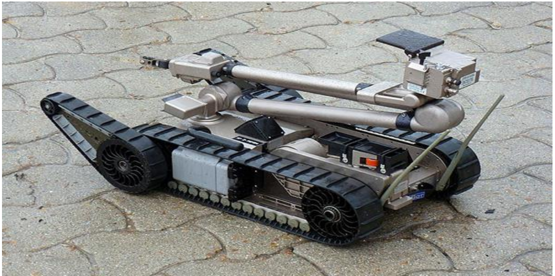
Şekil 1.1 : IRobot firması tarafından üretilen uzaktan kontrollü İKA olan PackBot [1].
