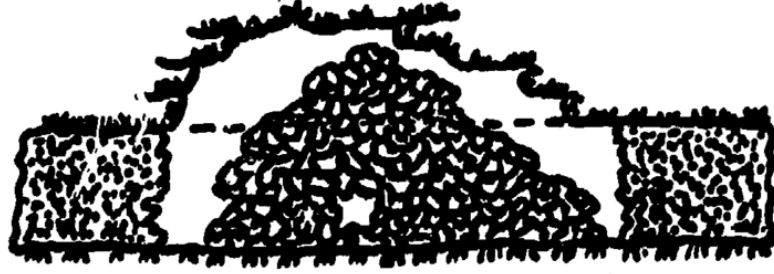
Şekil 1.2: Yeraltında kömür gazlaştırma işleminde görülen çatı çökmesi durumunun şematik gösterimi. Sağda ve solda koyu renk ile gösterilen yerler kömürü temsil etmektedir [3].
