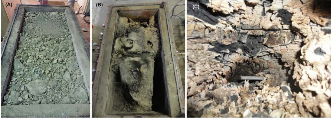
Şekil 1.8: Reaktör içersine yerleştirilen kömür örneğinin a) deneyden önce, b) deneyden sonra görünümü. c) Kömür bloğu içerisinde oluşan kavitenin(oyuk) görünümü [27].
