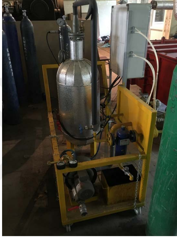
Şekil 3.1: Laboratuvar ölçekli YKG deney düzeneğine ait besleme düzeneği. Hareketli olarak tasarlanmış ünite üzerinde hava beslemesi için üfleç ve su buharı beslemesi için buhar kazanı görülmektedir.
