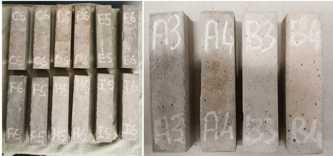
Şekil 3.2 : Basınç dayanımı ve karbonatlaşma direnci deneyleri için hazırlanan kontrol ve test numuneleri.
