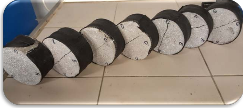
Şekil 3.3 : NT BUILD 492 klorür migrasyon katsayısı test numuneleri.
