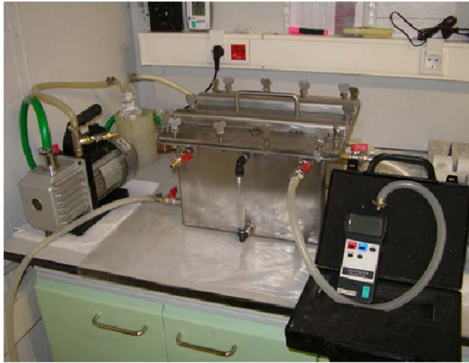
Şekil 2.12 : Numune vakum işlemi deney sistemi.
