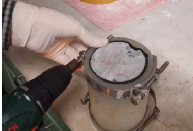
Şekil 2.13 : Test numunelerinin silikon kauçuk aparatlara yerleştirilmesi.
