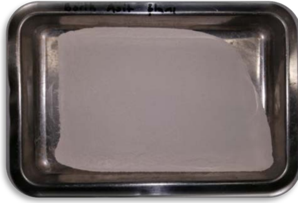
Şekil 2.8 : Öğütülmüş borjips atığı.
