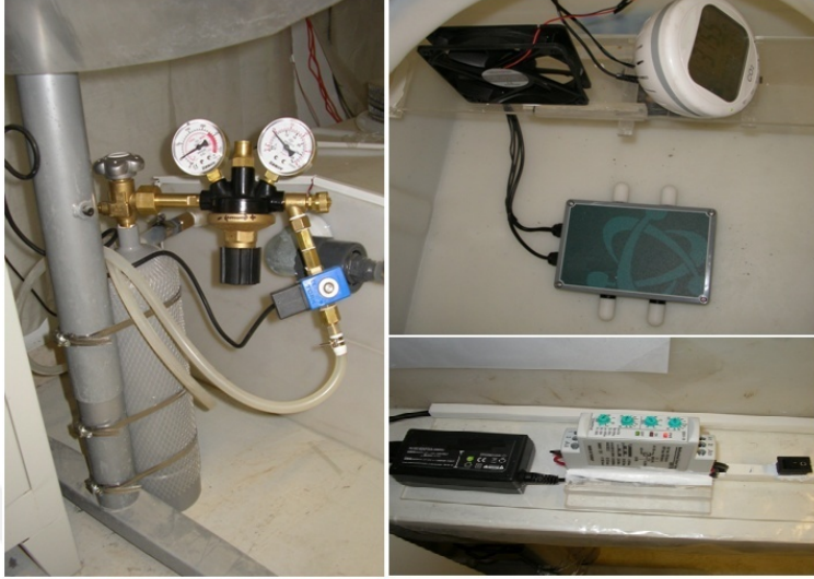
Şekil 2.22 : CO 2 gaz konsantrasyonu ölçüm ve akış kontrol sistemi.
