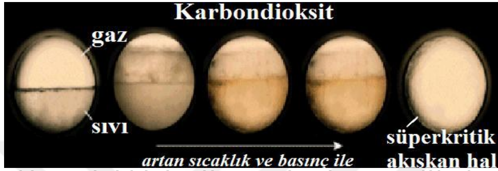
Şekil Hata! Belgede belirtilen stilde metne rastlanmadı..5. Artan sıcaklık ve basınç ile CO 2 'in süperkritik akışkan hale geçişinin şematik gösterimi
