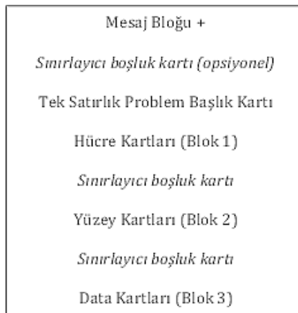
Şekil 3.1. MCNP input dosyasının genel yapısı (Shultis ve Faw, 2011)
