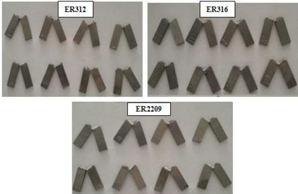
Şekil 4.25. Çentik darbe test numunelerin deney sonrası görüntüleri
